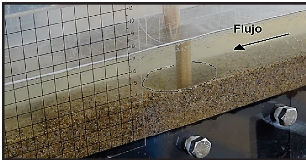
FIGURA. 4.2: DESARROLLO DE LA EROSIÓN (a) VISTA LATERAL DERECHA, (b) VISTA LATERAL IZQUIERDA
