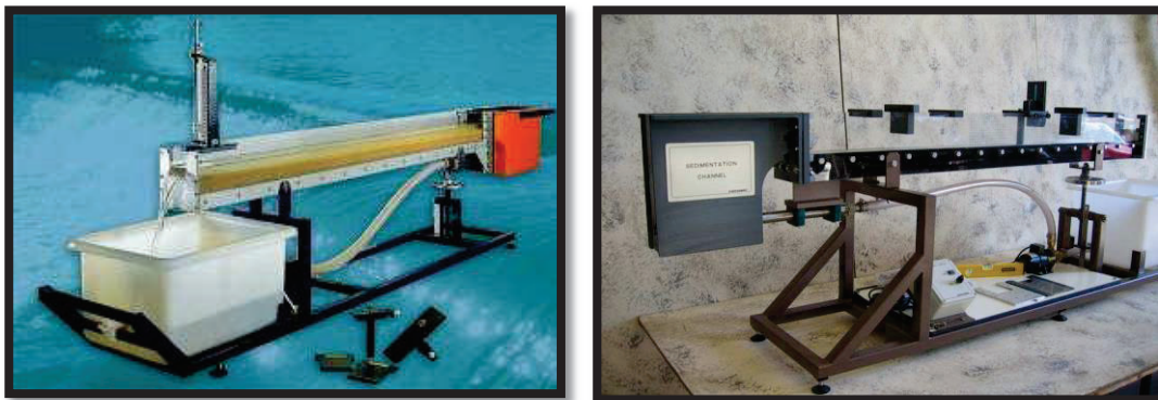
FIGURA 3.1: CANAL PARA DEMOSTRACIÓN DE TRANSPORTE DE SEDIMENTOS
