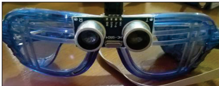
Figura 3. 22 Gafas con sensor de ultrasonido para detección de obstáculos.
