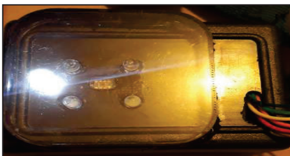
Figura 3. 13 Estructura para el sensor de color TCS230
