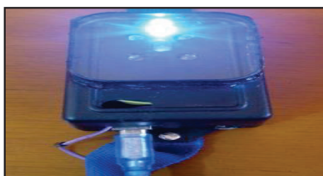
Figura 3. 9 Implementación de led y carcasa para control de incidencia de luz
