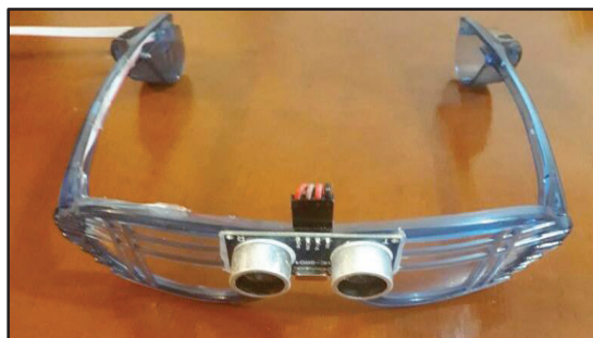
Figura 3. 6 Estructura para sensor de ultrasonido
