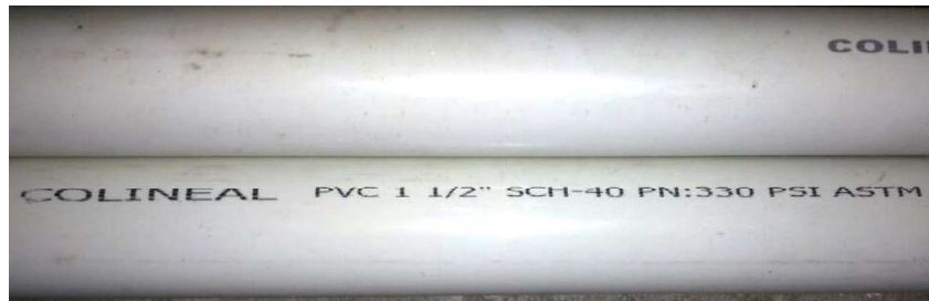
Figura 3.36. Tubería 1 1/2 SCH – 40 Fuente: Propia en domicilio
