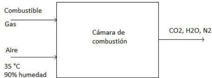
Figura 2.34. Mezcla aire combustible para combustión.
