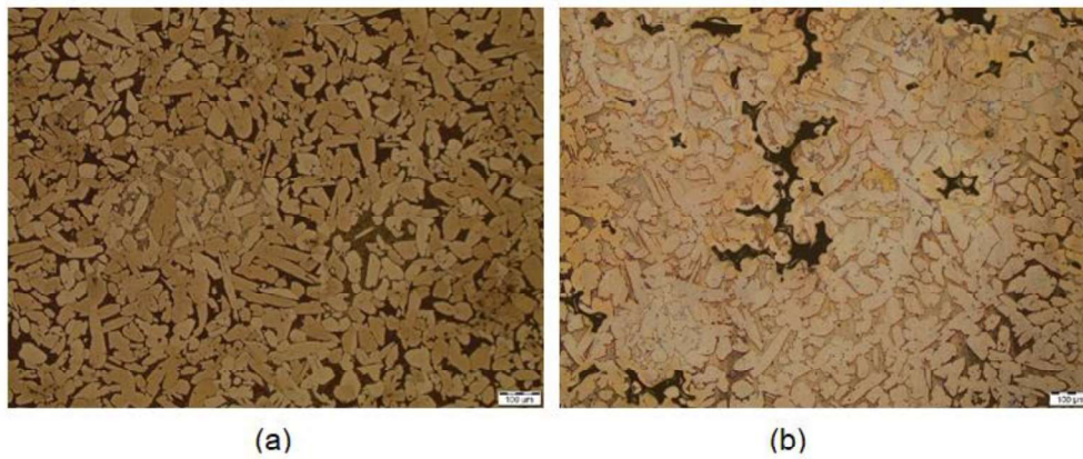
Figura 3.20. (a) CD6-1 (b) CD6-2. Aumento: 100X. Con ataque químico. Se observa una gran cantidad de granos de forma acicular sólida de fase alfa, los granos se encuentran dentro de una matriz de fase beta de color más oscuro. Se muestran manchas de color negro pertenecientes a microrechupes y porosidades en el material. Fuente: (Propia)
