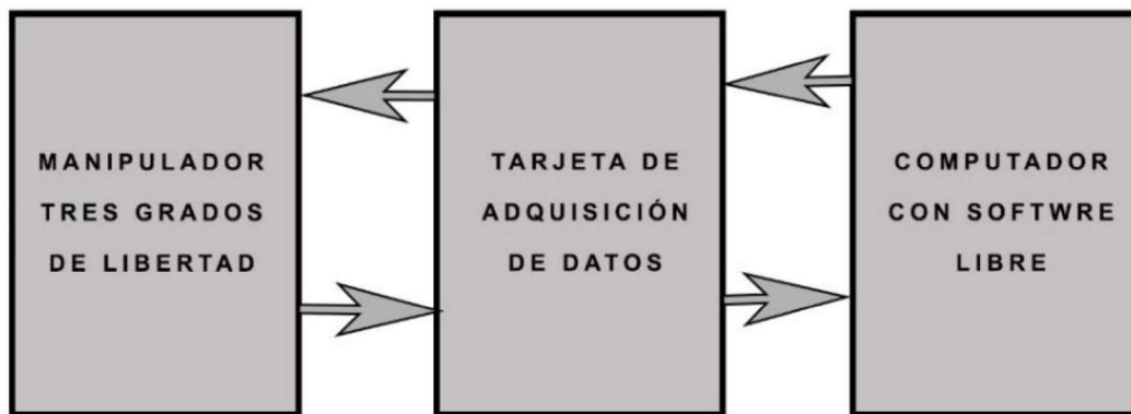
Figura 2.1. Diagrama en bloques del manipulador a implementar.
