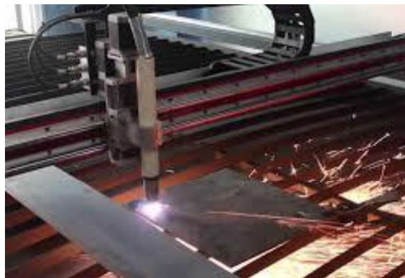
Figura 2.18. Proceso de corte de las piezas en una maquina CNC. (Fuente: Javier Acosta, 2018)
