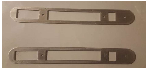
Figura 2.19. Partes del segundo eslabón cortado con una CNC de plasma. (Fuente: Javier Acosta, 2018)
