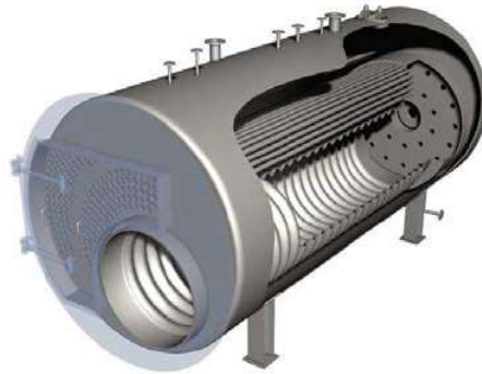
Figura 1.15. Cuerpo caldera pirotubular. (Fuente: [5])
