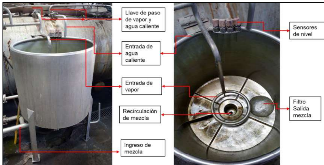
Figura 2.19. Tanque de mezclado de una máquina de tinturación. (Fuente: Autores)
