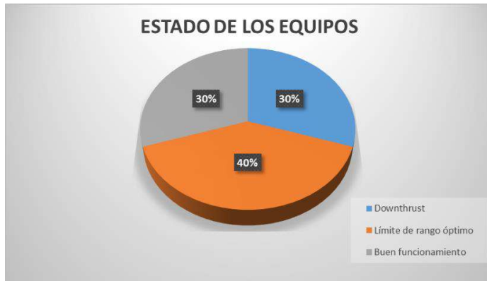
FIGURA 3.24. ESTADÍSTICA DE OPERACIÓN DE LOS EQUIPOS BES
