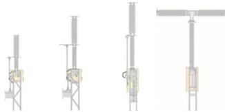
Figura 2.1 Interruptores de tanque vivo [5].
