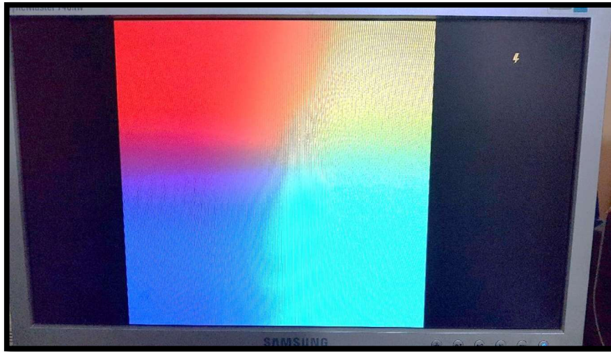
Figura 35. Error al ejecutar Ubuntu MATE en la Raspberry Pi 3 Model B+. (Fuente: Francisco Álvarez 2018)
