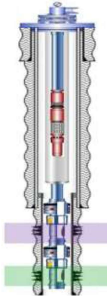
FIGURA 1. 12 SISTEMA BES ENCAPSULADO
