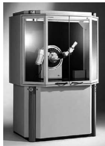
Figura 2. Difractómetro de rayos-X D8 Advance, DEMEX-EPN
