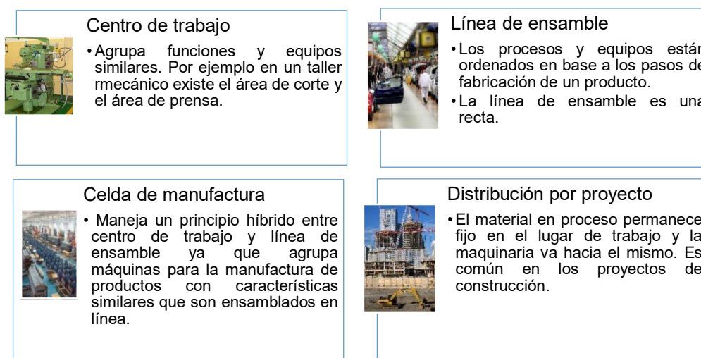
Figura 27 - Formatos básicos de distribución de instalaciones para la producción (Chase, Jacobs, & Aquilano, 2009)
