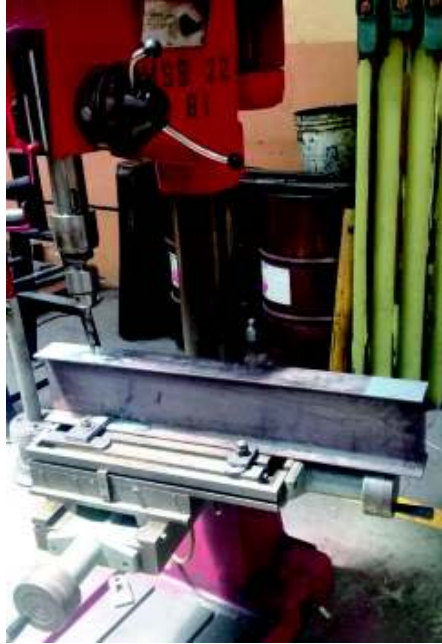
Figura 3. 2. Alojamiento de los asentamientos de los rodillos por medio del taladro vertical. (Fuente: Propia)
