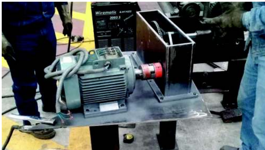
Figura 3. 15. Bastidor del motor y caja reductora. (Fuente: Propia)
