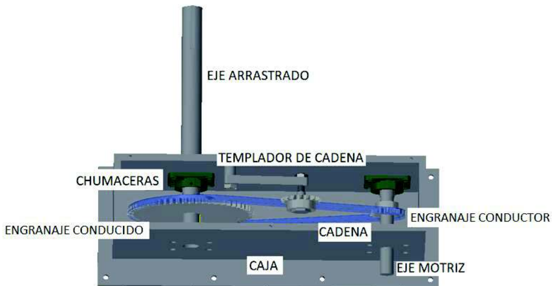
Figura 2. 6. Caja de reducción de velocidades. (Fuente: Propia)
