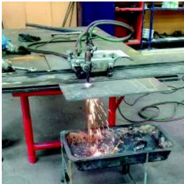
Figura 3. 9. Corte de las placas de la caja reductora de velocidades. (Fuente: Propia)
