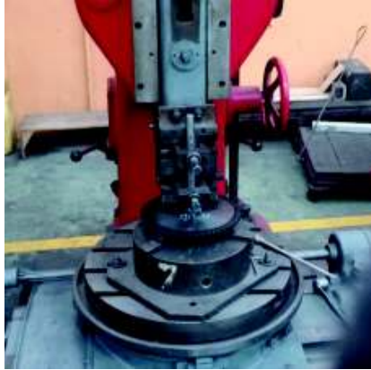
Figura 3. 8. Piñón conducido montada en la mortajadora. (Fuente: Propia)
