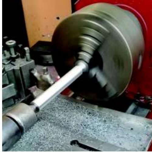
Figura 3. 4. Eje motriz montado en el torno para desbaste. (Fuente: Propia)
