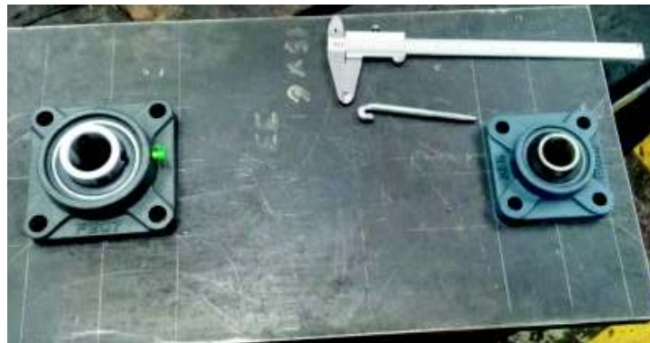
Figura 3. 11. Toma de medidas para asentamiento de chumaceras y ejes motriz y movido. (Fuente: Propia)
