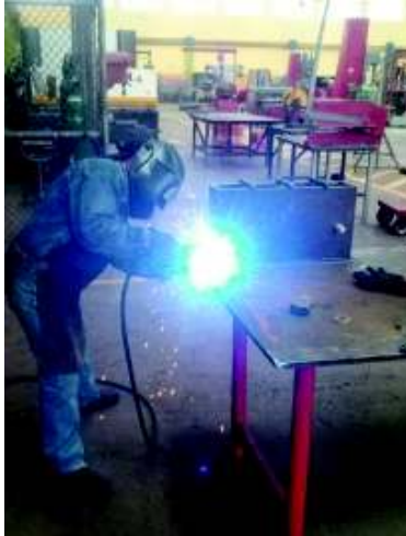
Figura 3. 12. Soldando las placas de la caja reductora de velocidades. (Fuente: Propia)
