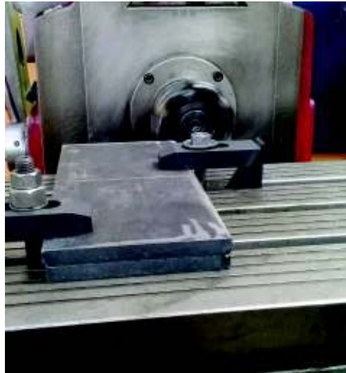
Figura 3. 10. Placas de la caja reductora montadas en la fresadora. (Fuente: Propia)
