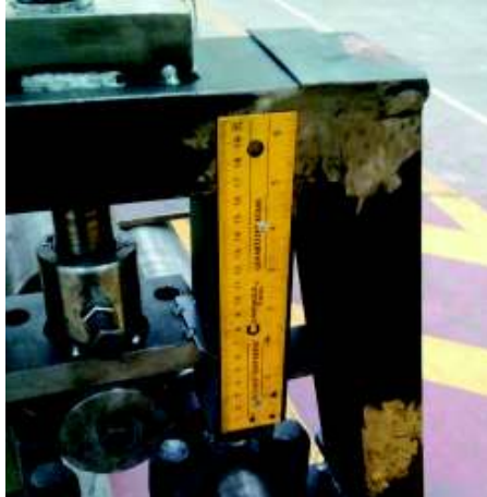
Figura 3. 19. Regleta metálica para señalar la altura del rodillo. (Fuente. Propia)
