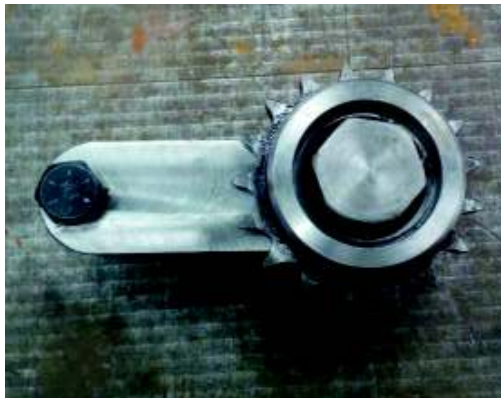
Figura 3. 13. Sistema templador de cadena. (Fuente: Propia)
