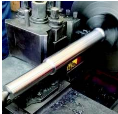
Figura 3. 5. Eje movido montado en el torno para el desbaste. (Fuente: Propia)
