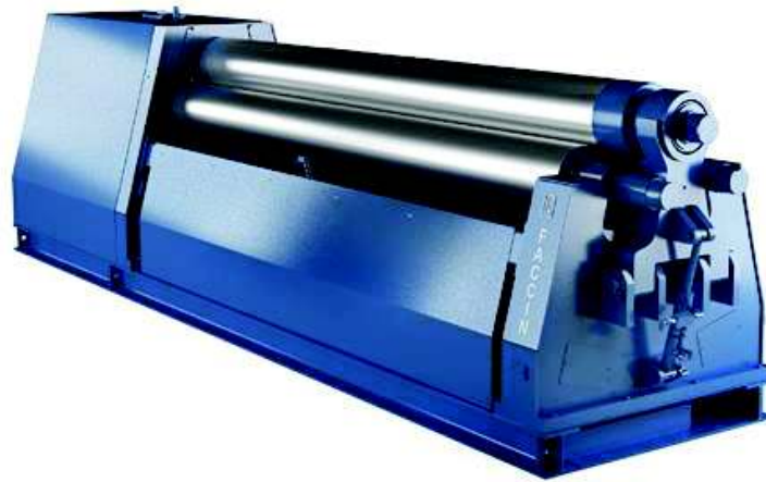
Figura 1. 3. Diagrama de una baroladora de tres rodillos.
