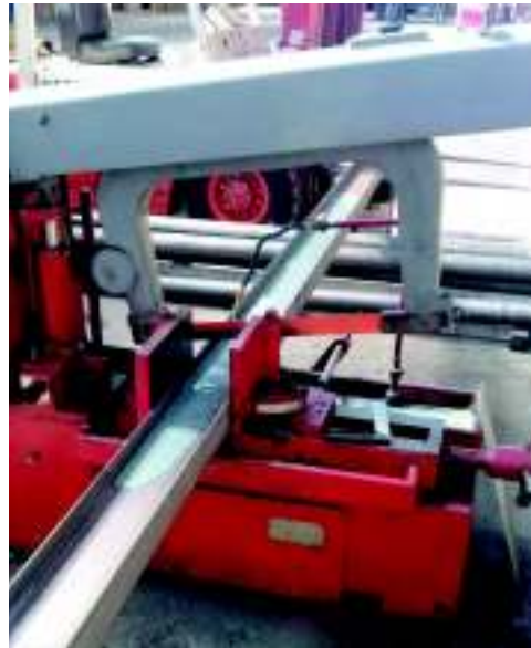
Figura 3. 1. Corte de perfil en I por medio de la sierra hidráulica. (Fuente: Propia)
