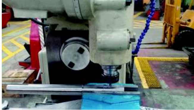
Figura 3. 6. Eje movido montado en la fresadora. (Fuente: Propia)
