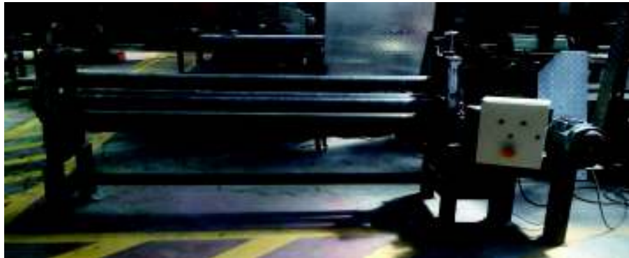
Figura 3. 20. Prototipo de baroladora conjunto completo ensamblado. (Fuente. Propia)
