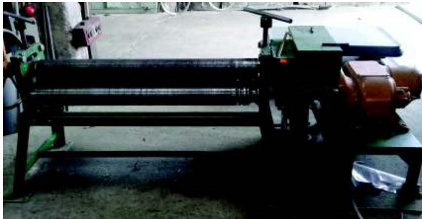
Figura 1. 10. Prototipo de baroladora de TEXPA. (Fuente: Propia)
