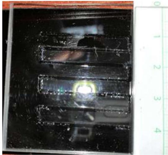
Figura 3.6. Piezas de acrílico negro y transparente soldadas con la máquina prototipo para la muestra 035 de la Tabla 3.3. La trayectoria de soldadura corresponde a la mostrada en la Fig. 3.5.
