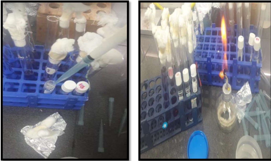
Figura 29. Colocación de dilución con micropipeta y puntas FUENTE: (El Autor,2018)
