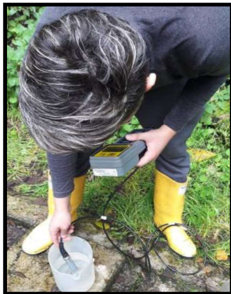
Figura 10. Determinación de conductividad FUENTE: (El Autor,2018)
