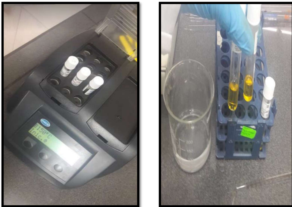
Figura 14. Determinación de la demanda química de oxígeno (DQO) FUENTE: (El Autor,2018)
