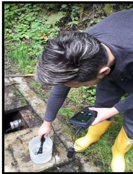
Figura 13. Determinación de oxígeno disuelto FUENTE: (El Autor,2018)
