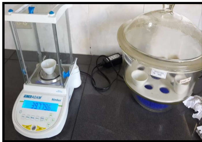
Figura 17. Determinación de sólidos totales FUENTE: (El Autor,2018)
