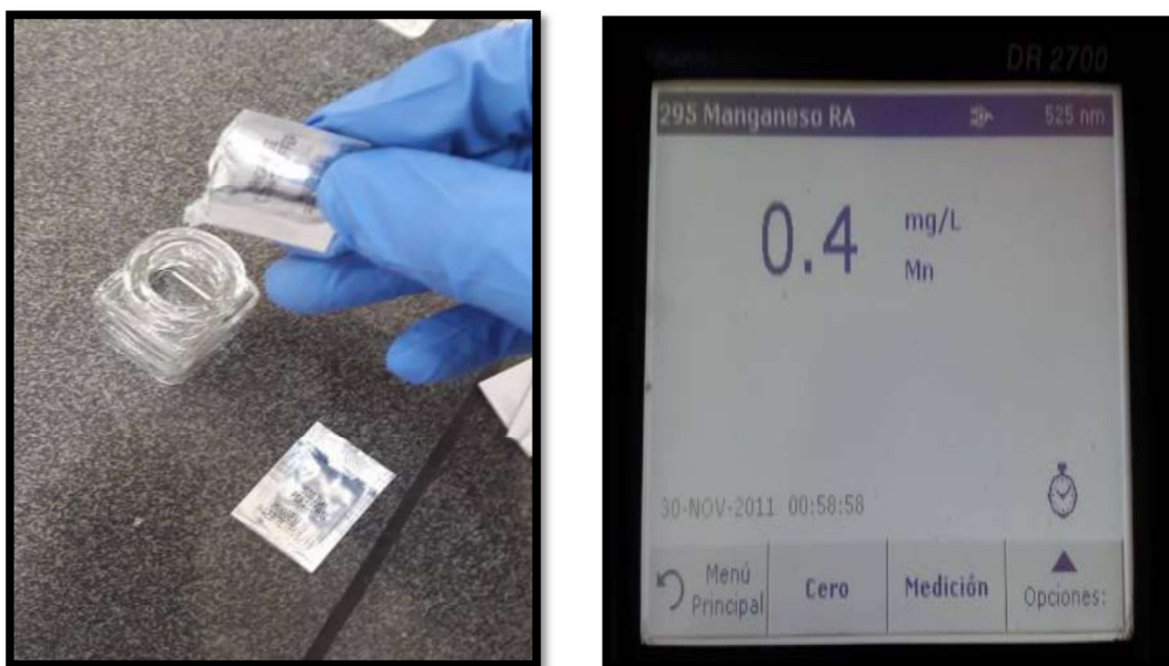
Figura 21. Determinación de manganeso FUENTE: (El Autor,2018)
