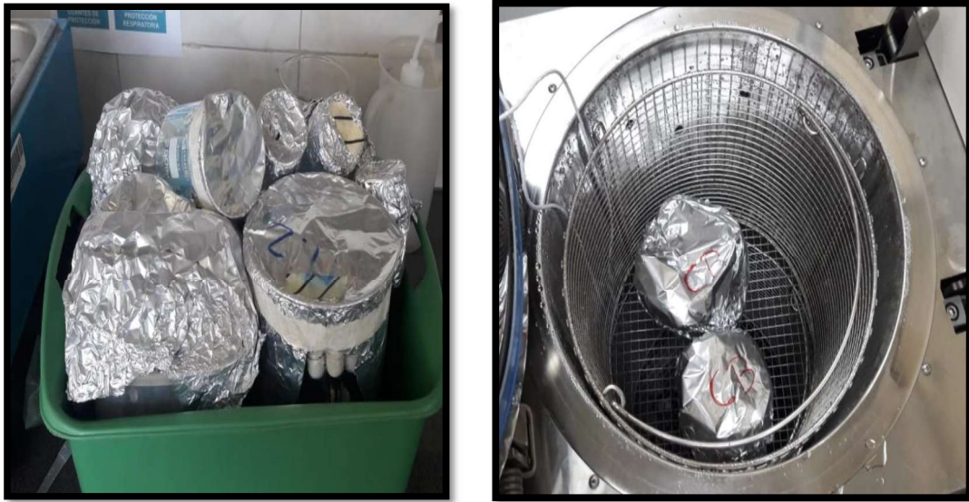
Figura 28. Colocación en recipientes para su posterior esterilización en autoclave FUENTE: (El Autor,2018)
