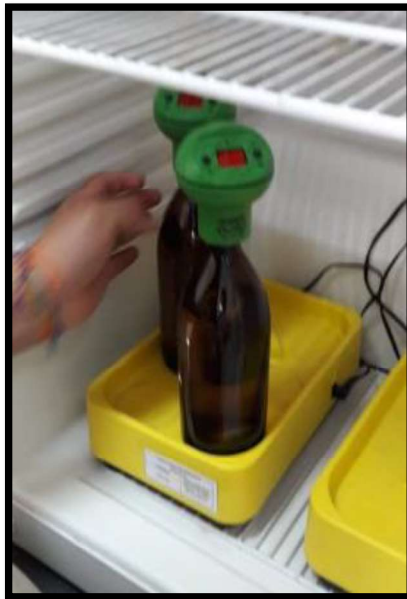
Figura 15. Determinación de la demanda biológica de oxígeno ( DBO_5 ) FUENTE: (El Autor,2018)
