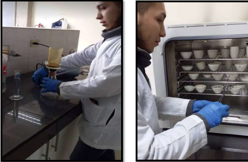
Figura 16. Determinación de sólidos disueltos totales FUENTE: (El Autor,2018)
