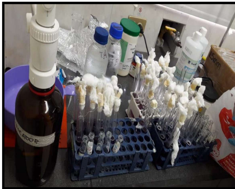
Figura 27. Sello con tampones hechos de gasa o algodón FUENTE: (El Autor,2018)
