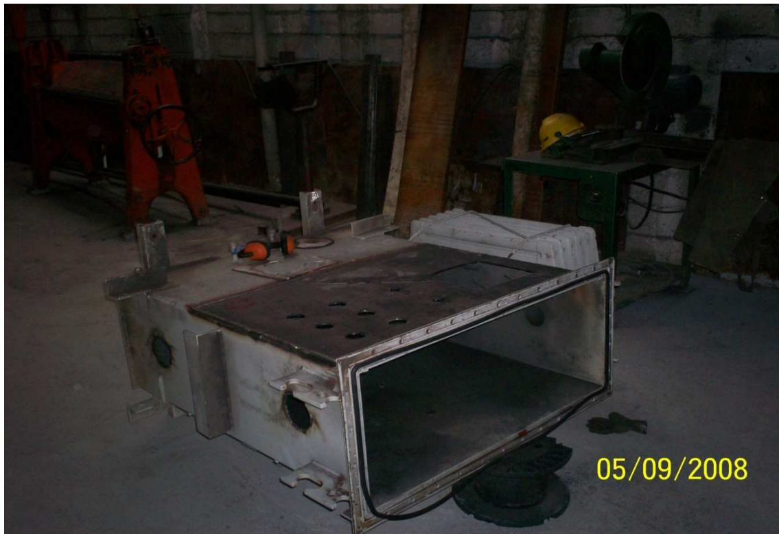
Fotografía 5.6 (Tanque con perforaciones listas para acoplar los radiadores)
