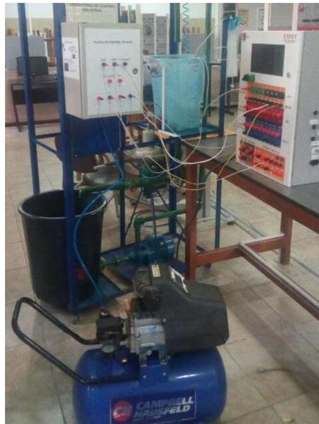
Figura 43. Planta de control por presión con unidad central de presión.
