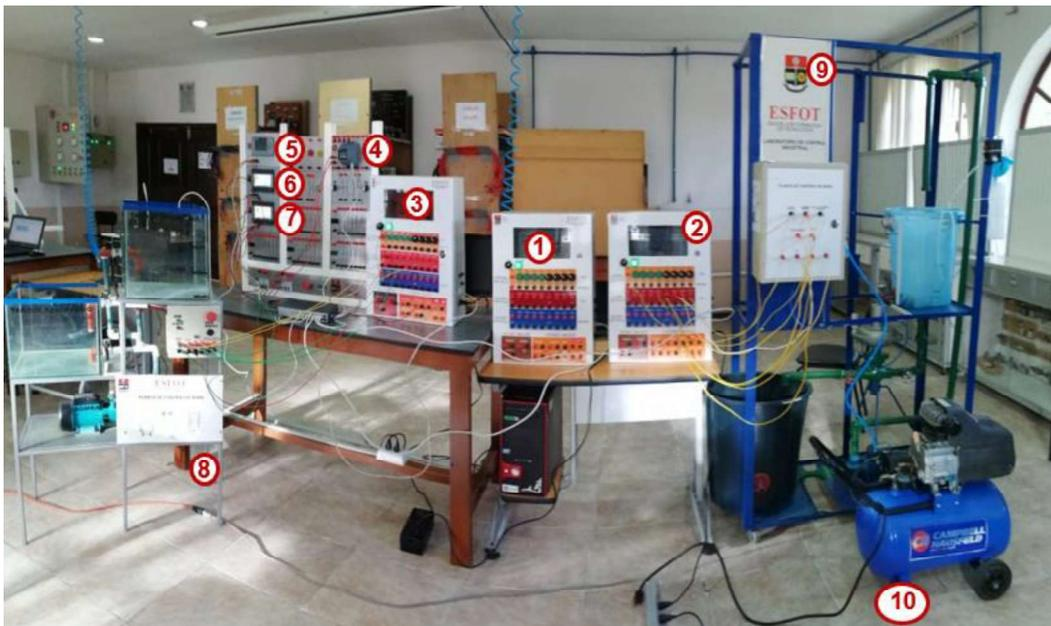
Figura 41. Dispositivos industriales formando un SCADA.
