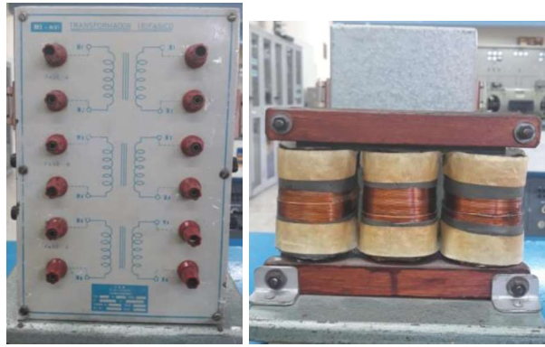
Figura 2.1. Transformador trifásico bajo prueba ubicado en el Laboratorio de Maquinas Eléctricas de la EPN.
