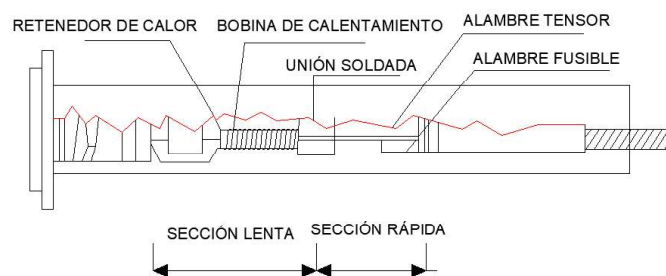
Figura 1.4. Estructura del fusible dual. [12].
