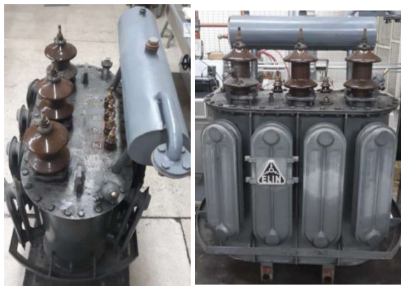
Figura 2.2 Transformador trifásico de 50 [kVA] bajo prueba ubicado en el Laboratorio de Alto Voltaje de la EPN.
