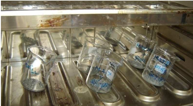
FIGURA 5.19: SECADO DE MUESTRAS EN EL HORNO
