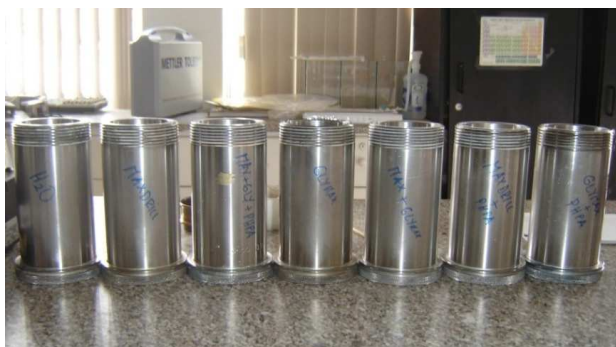
FIGURA 5.18: MUESTRAS DE CADA FLUIDO EN LOS ENVASES DEL HORNO DE ROLADO
