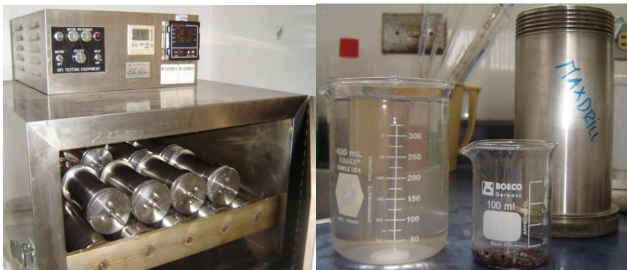
FIGURA 5.27: ROLADO Y MUESTRA DE FLUIDO MAXDRILL DE LA FORMACIÓN TENA
