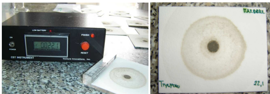
FIGURA 5.38: EJEMPLO PRUEBA CST PARA FLUIDO BASE AMINA
