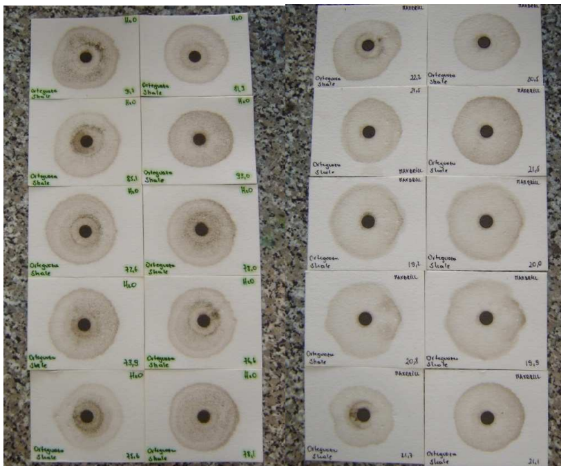
FIGURA 5.39: PRUEBAS DE CST PARA LA FORMACIÓN ORTEGUZA CON FLUIDO MAXDRILL (DERECHA) Y FLUIDO BLANCO (IZQUIERDA)
