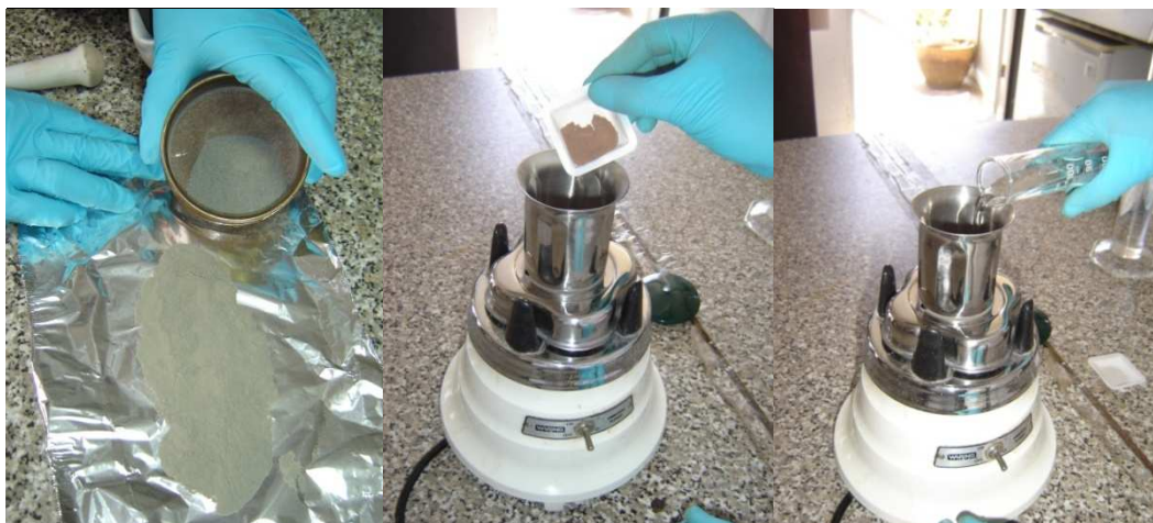
FIGURA 5.36: PREPARACIÓN DE FLUIDO PARA LA PRUEBA CST
