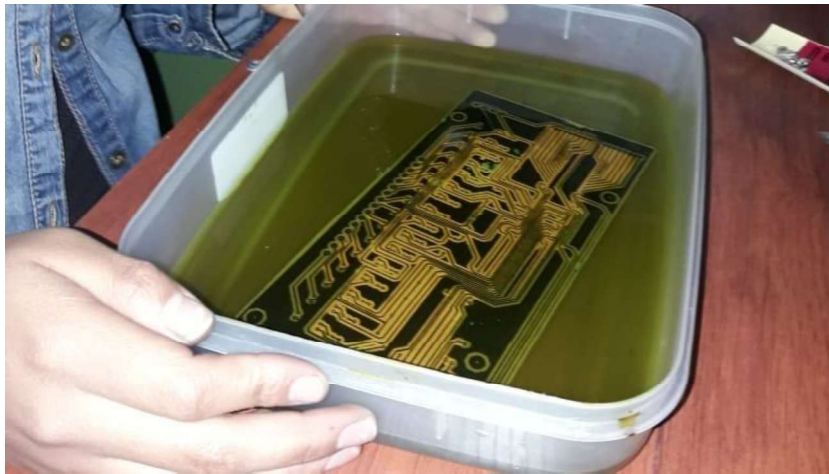
Figura 3.30. Placa sumergida en una solución de cloruro férrico y agua.
