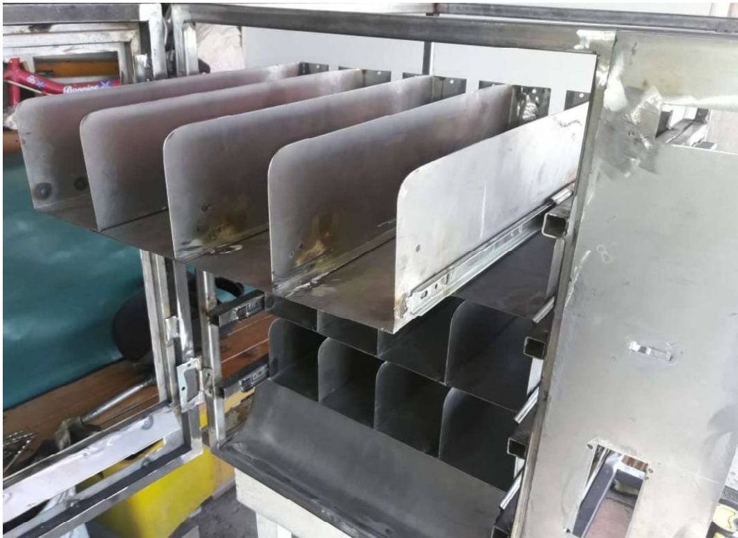
Figura 3.42. Bandejas de la estructura.
