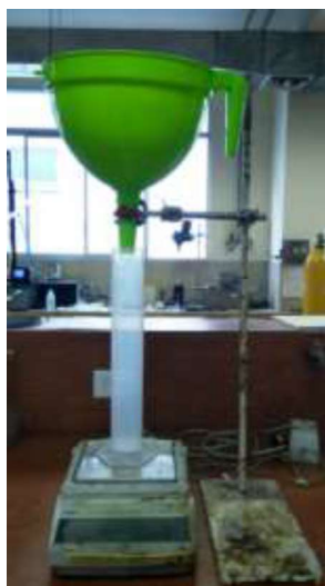
Figura 2.2. Montaje del equipo para determinación de densidad aparente de virutas de cuero
