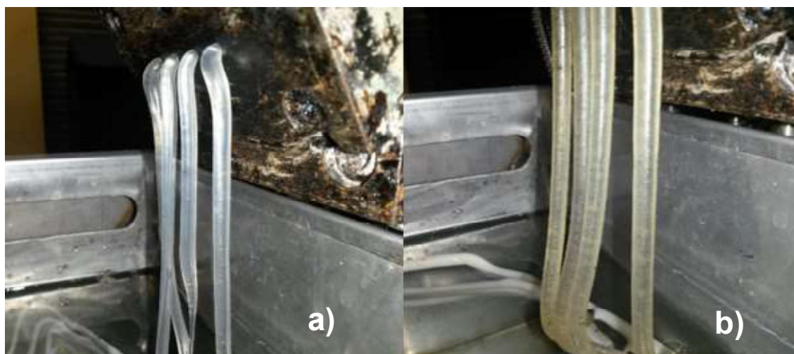
Figura 3.8. Fotografías de PEAD-EVA extruido a las mismas condiciones de temperatura (1:90 °C; 2:135 °C; 3:145 °C; 4:165 °C; 5:170 °C; 6: 175 °C; 7:180 °C a) composición 90 % - 10 %, b) composición 75 % - 25 %
