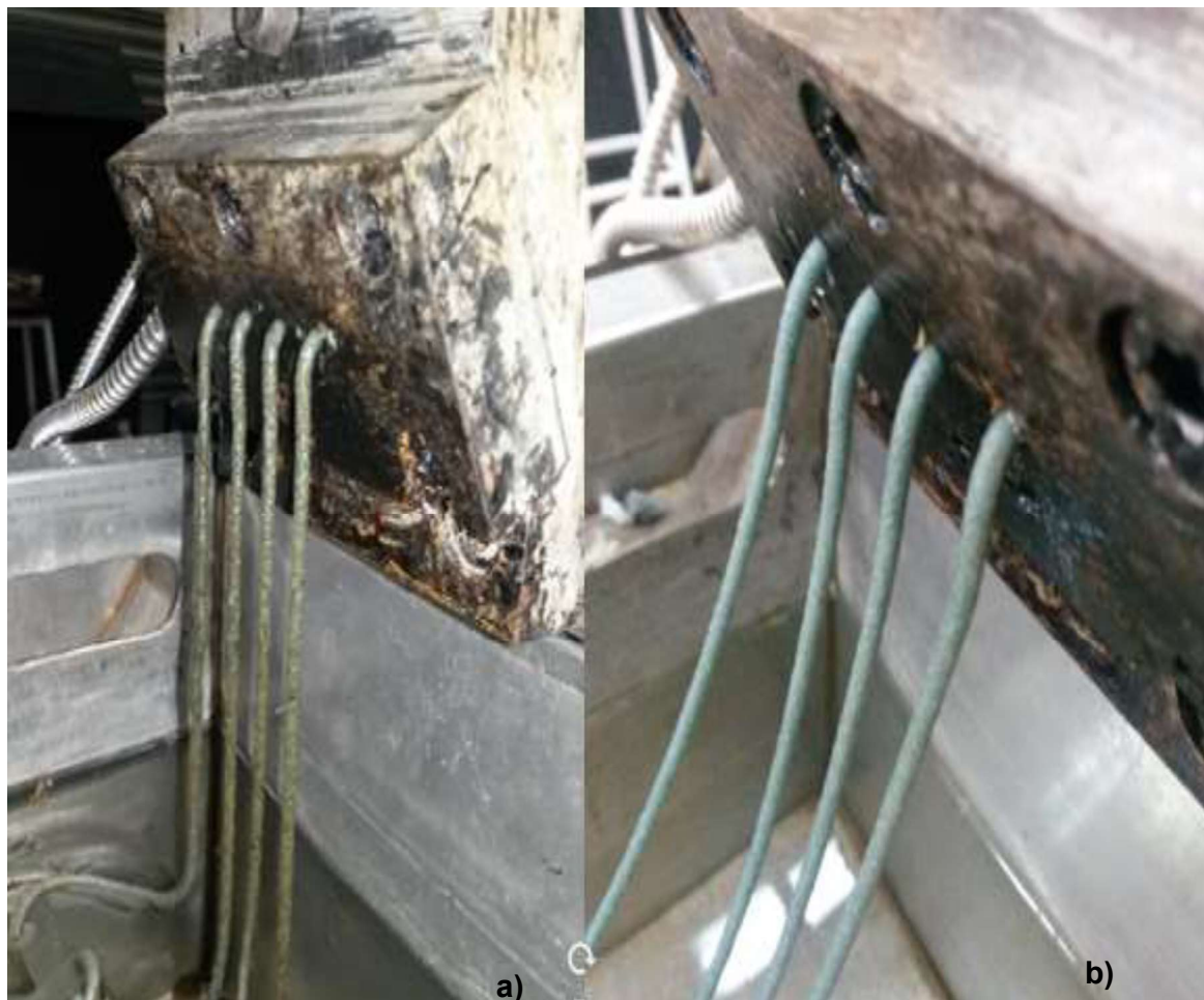
Figura 3.13. Fotografía de PEAD-EVA y virutas de cuero: a) material extruido con velocidad de giro del doble husillo menor a las velocidades de dosificación de las tolvas secundarias, b) material extruido con velocidad de giro del doble husillo mayor a las velocidades de dosificación de las tolvas secundarias
