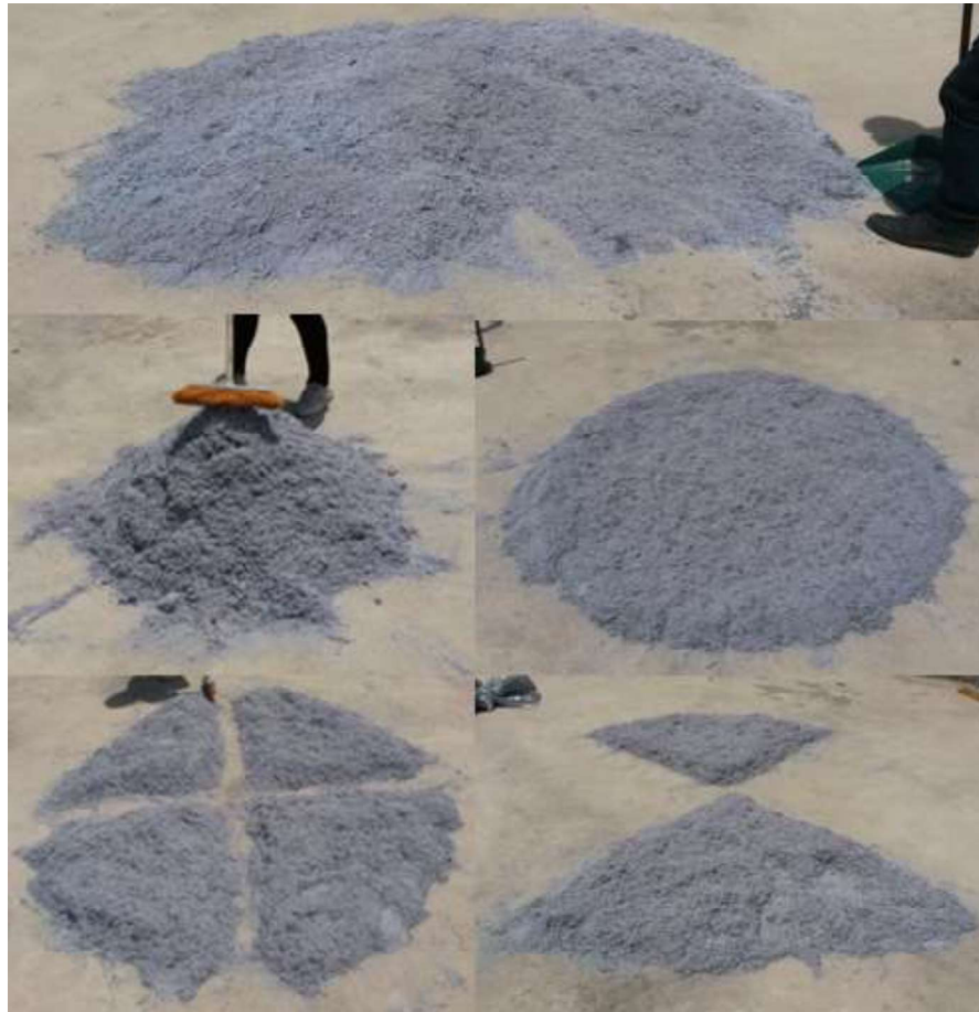
Figura 2.1. Proceso de homogenización y reducción de la muestra de virutas de cuero
