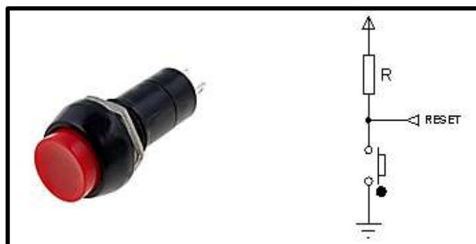
Figura 3.35 Conexión pulsador RESET Elaboración: Propia
