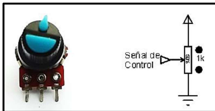
Figura 3.36 Conexión del Potenciómetro Elaboración: Propia
