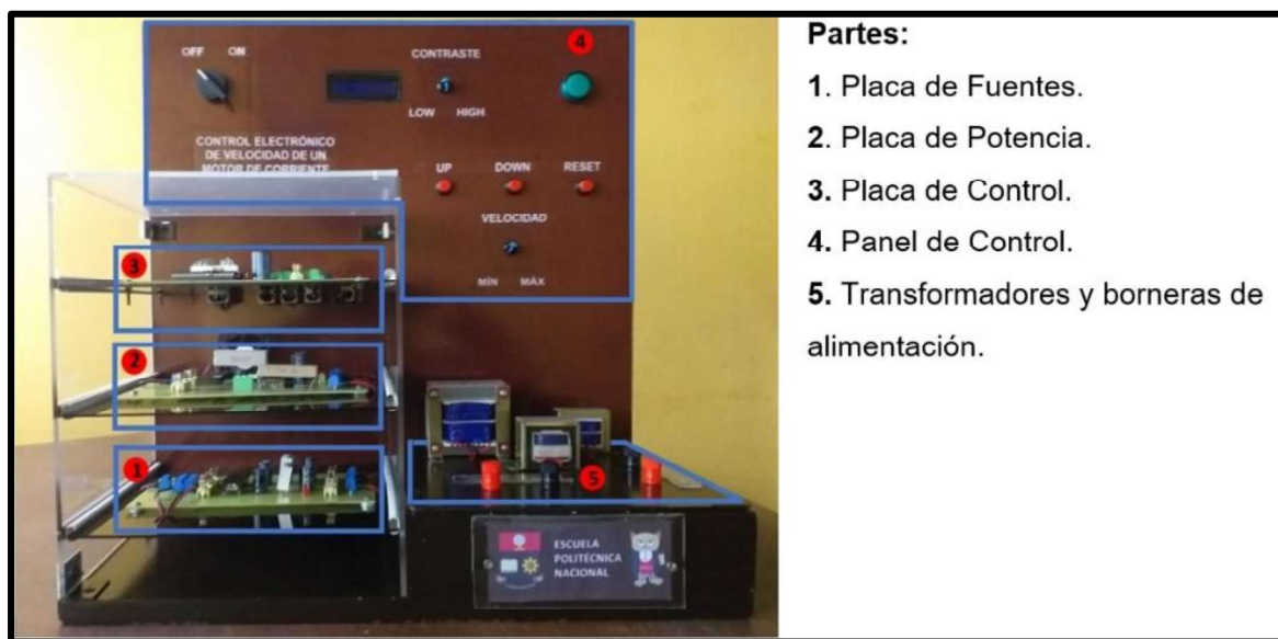
Figura 3.28 Partes Principales del Módulo Didáctico Elaboración: Propia
