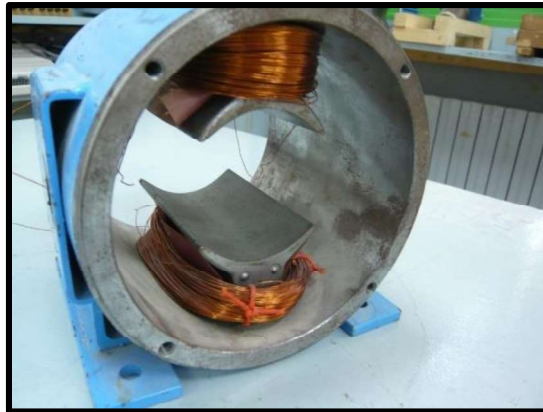
Figura 1.3 Estator de un motor DC [3]
