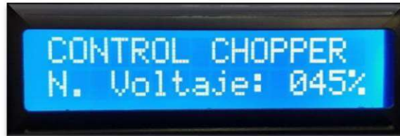
Figura 3.19 Visualización Control Chopper Elaboración: Propia
