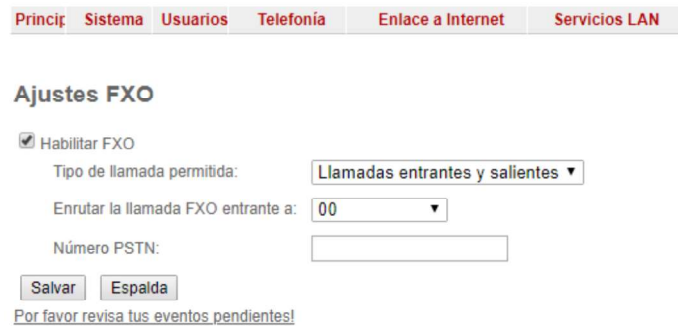
Figura 59 Resumen ajustes FXO Fuente: Módulo ajuste FXO Quadro 2x
