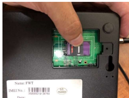
Figura 45 Colocación de chip GSM en base celular Fuente: Base celular en Laboratorio TIC'S
