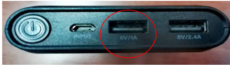
Figura B.15 Puertos del banco de baterías.
