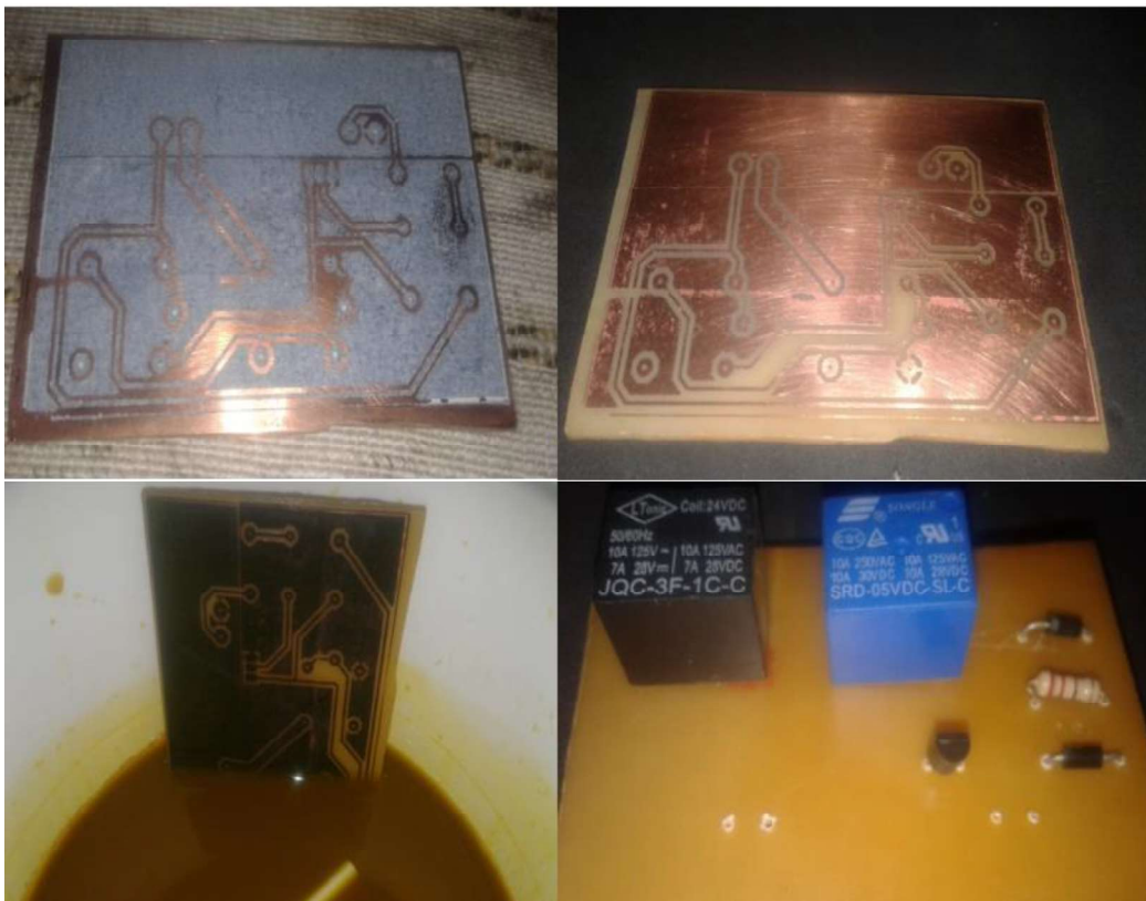
Figura 3.25 Proceso de construcción de la placa.
