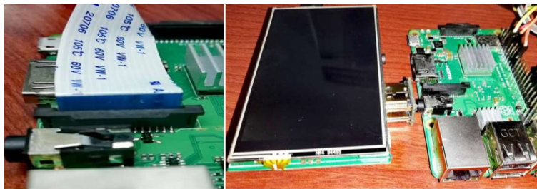
Figura C1.1 Desconexión de cámara PiNoir y pantalla LCD.
