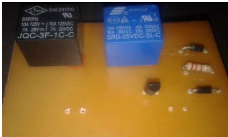
Figura B.11 Placa de circuito de control electrónico.
