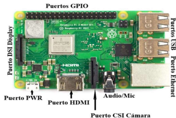
Figura 1.1 Estructura del módulo Raspberry. [8]
