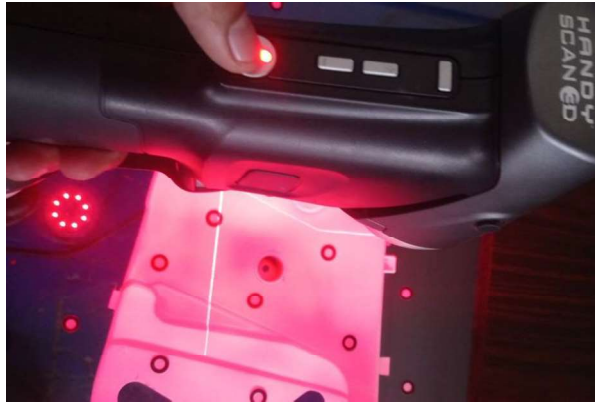
Figura 3.42. Forma de haz luz del escáner portátil “tipo lineal”. (Fuente: Propia)
