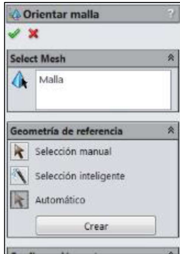
Figura 3.75. Selección automática para la orientación de malla. (Fuente: Propia)
