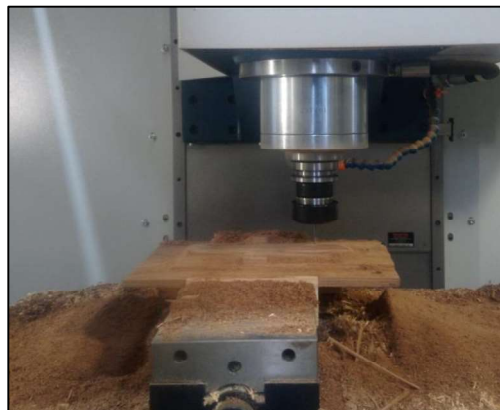
Figura 3.172. Fabricación del molde tipo macho de la propela. (Fuente: Propia)
