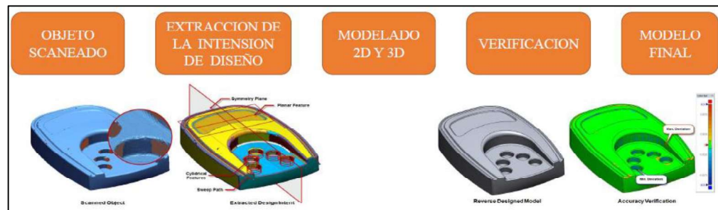
Figura 2.6. Metodología de básica de la utilización del software Geomagic Design X. (Fuente: Propia)
