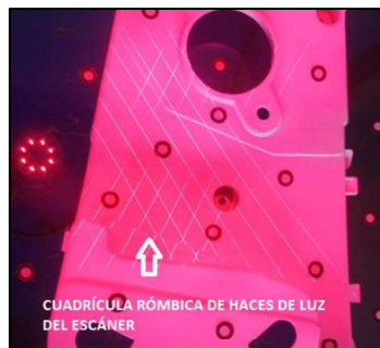
Figura 3.41. Forma de haces luz del escáner portátil “tipo rombos”. (Fuente: Propia)
