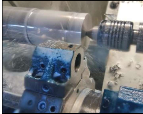
Figura 3.155. Mecanizado en forma automática en Torno CNC. (Fuente: Propia)
