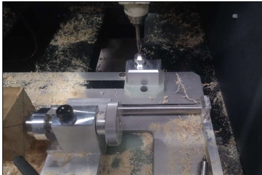
Figura 3.131. Sensor del cuarto eje para referenciar. (Fuente: Propia)
