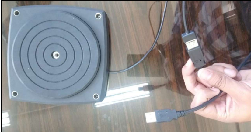
Figura 3.25. Conexión de la mesa giratoria del escáner fijo. (Fuente: Propia)
