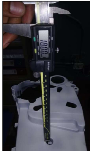
Figura 3.109. Obtención directa de información mediante instrumento de medida “calibrador pie de rey”. (Fuente: Propia)
