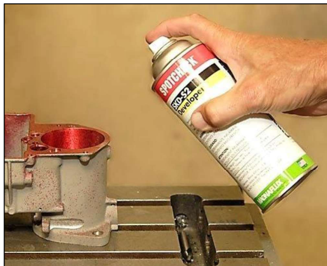
Figura 3.17. Revelador de tintas penetrantes. (Fuente: http://tablaroca.co/skd-s2-developer/skd-s2-developer-spotcheck/ )
