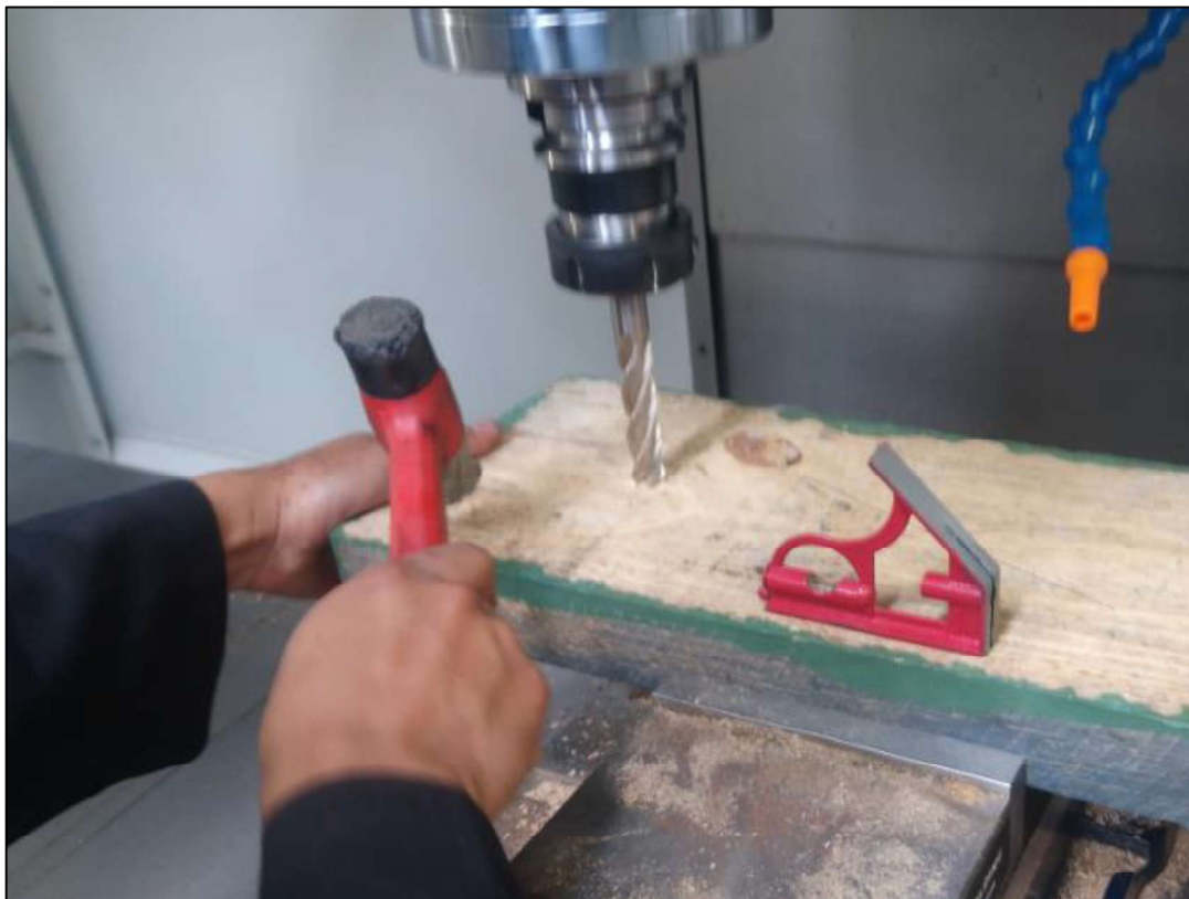
Figura 3.168. Procedimiento de colocación del material y medición de la longitud de la herramienta. (Fuente: Propia)
