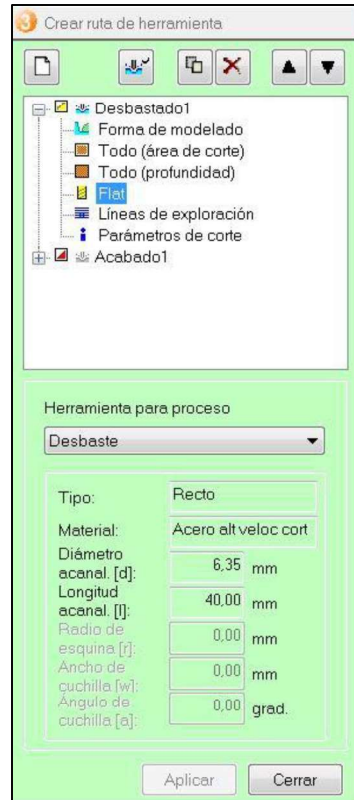
Figura 3.125. Operación de desbaste y selección de herramienta. (Fuente: Propia)
