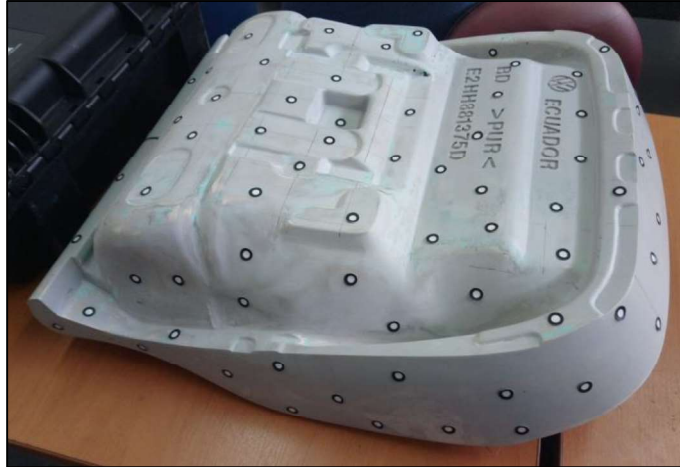
Figura 3.16. Colocación de los targets en el objeto de referencia. (Fuente: Propia)
