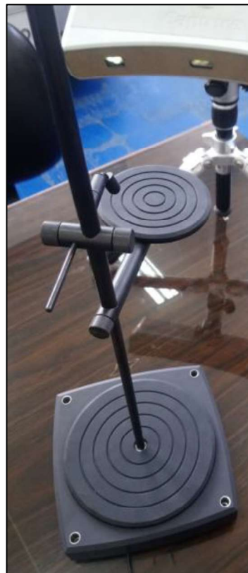
Figura 3.26. Elementos adicionales de soporte del objeto de referencia del escáner fijo. (Fuente: Propia)
