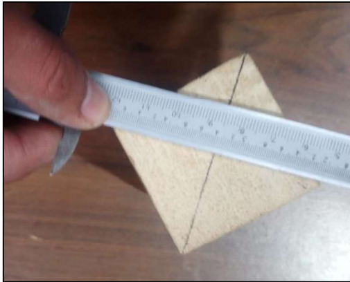
Figura 3.132. Trazado de diagonales para buscar el centro de la pieza. (Fuente: Propia)
