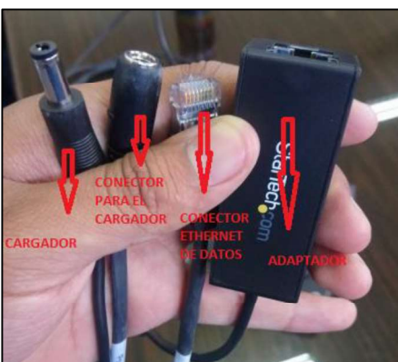
Figura 3.23. Operación de conexión de los cables del escáner fijo. (Fuente: Propia)
