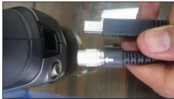
Figura 3.20. Operación de conexión del escáner portátil. (Fuente: Propia)
