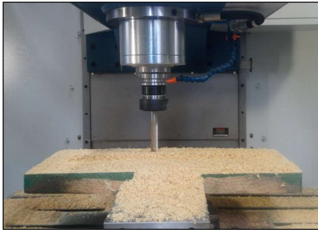
Figura 3.171. Centro de mecanizado trabajando de forma automática la pieza del molde tipo hembra. (Fuente: Propia)
