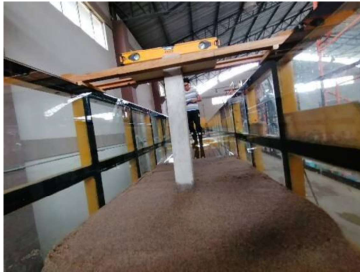
Fotografía No. 3.4: INSTALACIÓN DE PILA CUADRADA EN EL LECHO.
