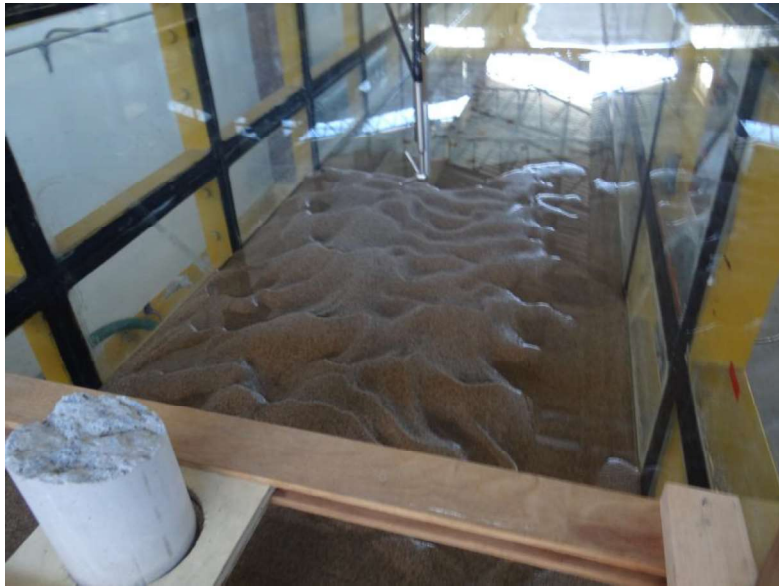
Fotografía No. 4.3: CONDICIÓN FINAL DEL LECHO DE ARENA. PILA CIRCULAR
