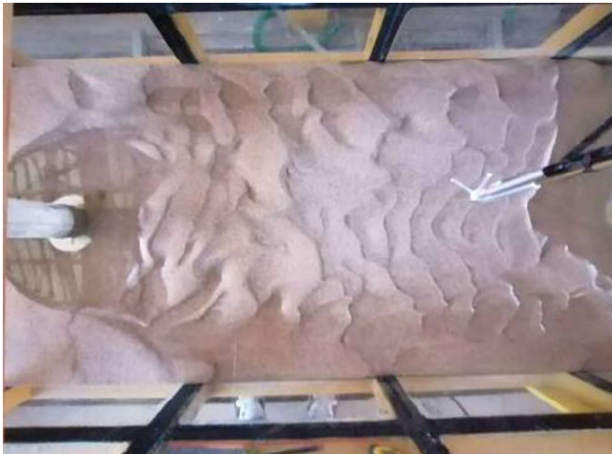
Fotografía No. 4.4: CONDICIÓN FINAL DEL LECHO DE ARENA. PILA CIRCULAR
