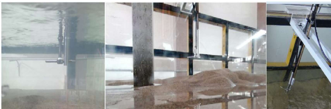
Fotografía No. 3.16: INSTALACIÓN DEL ACOUSTIC DOPPLER VELOCIMETER (ADV)
