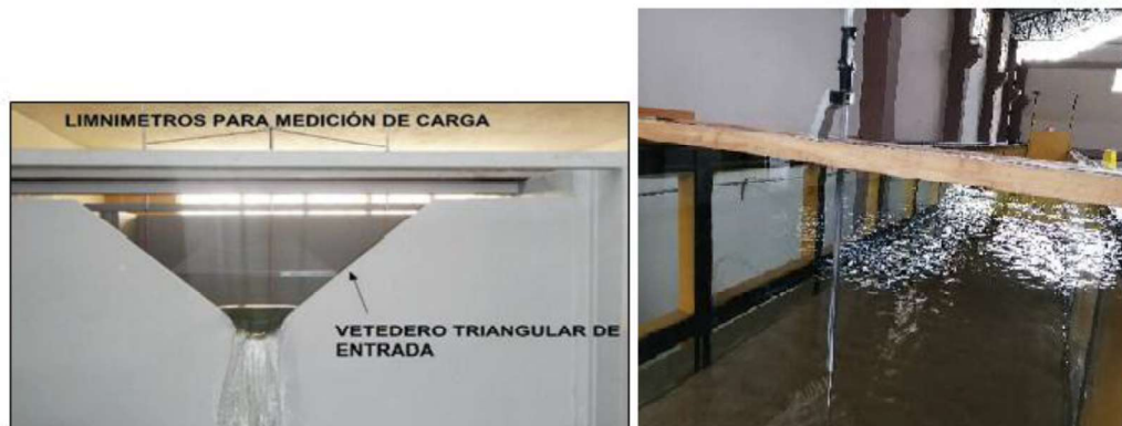
Fotografía No. 3.12: LIMNIMETROS Y VERTEDERO
