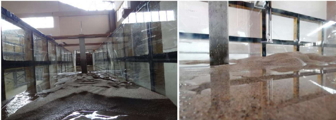
Fotografía No. 4.2: CONDICIÓN FINAL DEL LECHO DE ARENA. PILA CUADRADA
