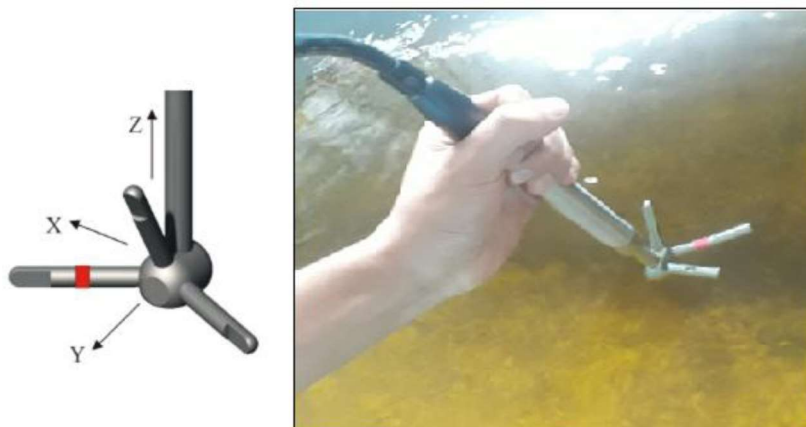
FIGURA 3-11. UBICACIÓN DE LOS RECEPTORES EN EL ACOUSTIC DOPPLER VELOCIMETER (ADV)
