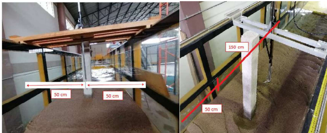
Fotografía No. 3.8: UBICACIÓN DE LAS PILAS EN EL LECHO.
