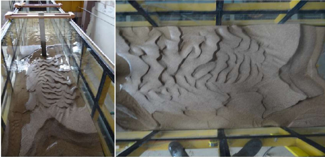
Fotografía No. 4.1: CONDICIÓN FINAL DEL LECHO DE ARENA. PILA CUADRADA
