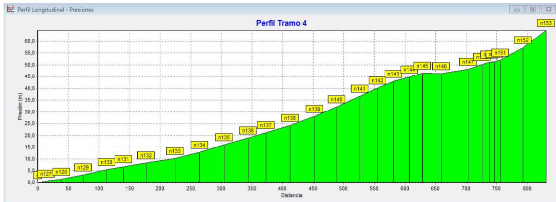
FIGURA 50-VARIACIÓN DE PRESIÓN VS DISTANCIA- TRAMO TANQUE ROMPE PRESIONES JATUMPUNGO-TANQUE ROMPE PRESIONES MUSHUÑAN 1.
