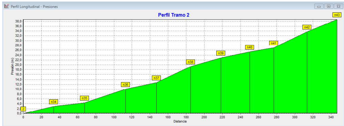
FIGURA 48-VARIACIÓN DE PRESIÓN VS DISTANCIA- TRAMO TANQUE ROMPE PRESIONES LORETO 1-TANQUE ROMPE PRESIONES LORETO 2.
