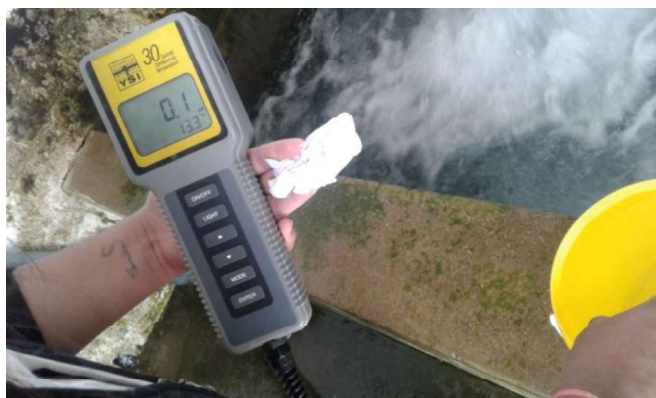
FIGURA 18- MEDICIÓN DE CONDUCTIVIDAD EN SITU, SECTOR LORETO.
