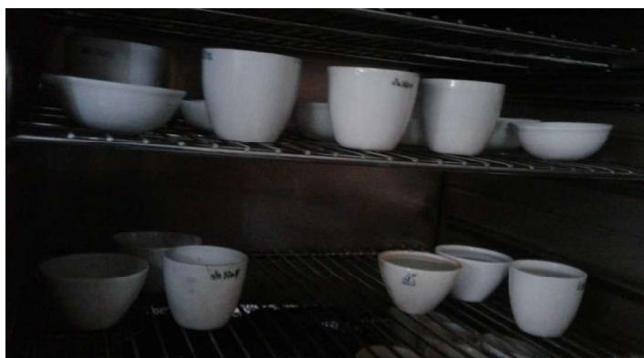
FIGURA 25- CRISOLES Y PLATILLOS EN LA ESTUFA PARA SU ESTERILIZACIÓN.
