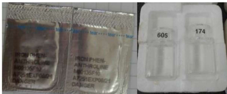
FIGURA 20- REACTIVOS Y CELDAS PARA EL ANÁLISIS DE HIERRO TOTAL.
