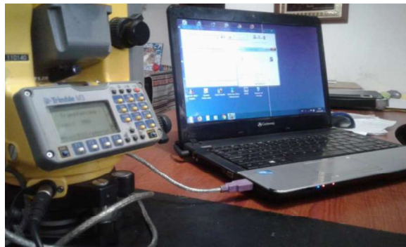
FIGURA 8- DESCARGA DE LA NUBE DE PUNTOS AL COMPUTADOR.
