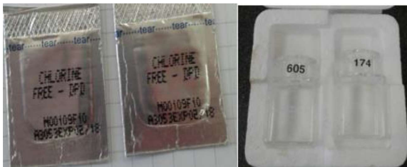
FIGURA 19-REACTIVOS Y CELDAS PARA EL ANÁLISIS DE CLORO LIBRE.
