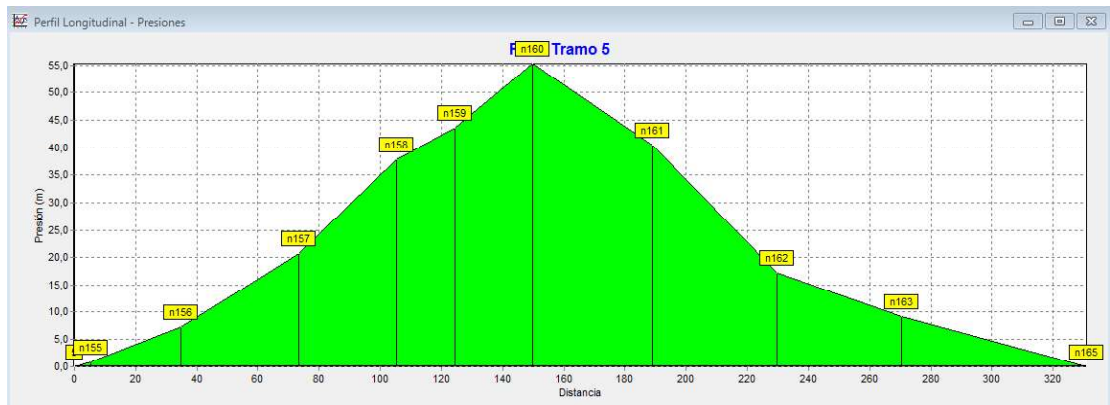
FIGURA 51-VARIACIÓN DE PRESIÓN VS DISTANCIA- TRAMO TANQUE ROMPE PRESIONES MUSHUÑAN 1-TANQUE ROMPE PRESIONES MUSHUÑAN 2
