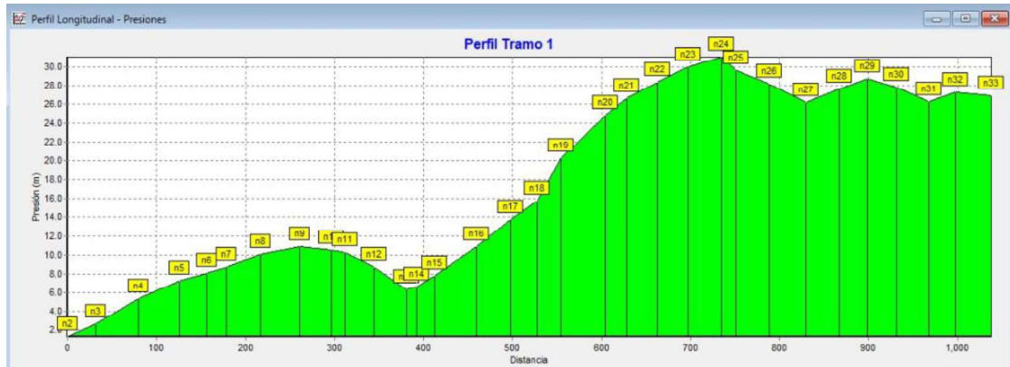
FIGURA 47-VARIACIÓN DE PRESIÓN VS DISTANCIA- TRAMO TANQUE DISTRIBUIDOR LORETO-TANQUE ROMPE PRESIONES 1.
