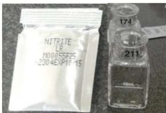
FIGURA 21- REACTIVO Y CELDAS PARA EL ANÁLISIS DE NITRITOS.
