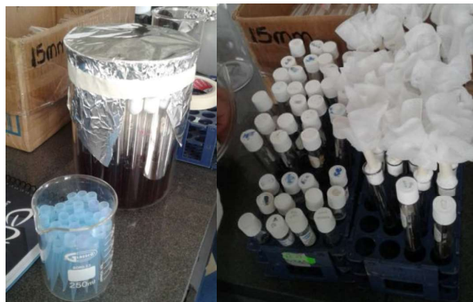
FIGURA 30- ESTERILIZACIÓN DE LOS TUBOS DE ENSAYO Y LAS PUNTAS DE PLÁSTICO.
