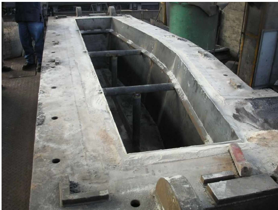
Figura 5. Tundysh o distribuidor
