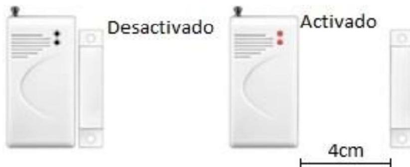
*Figura 3.9 Activación del sensor magnético.*
