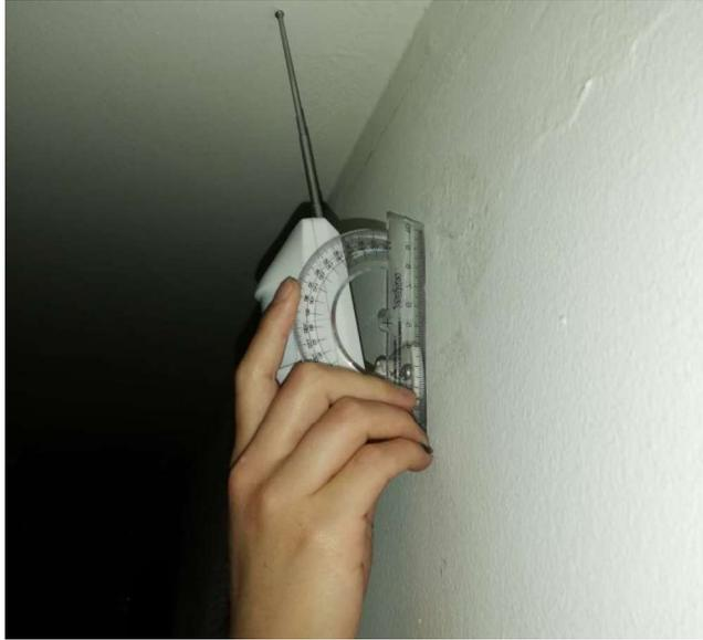
*Figura 3.21 Ajuste del ángulo de cobertura con ayuda de un graduador.*
