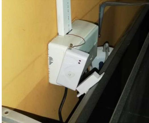
*Figura 3.17 Sensor Magnético Instalado*
