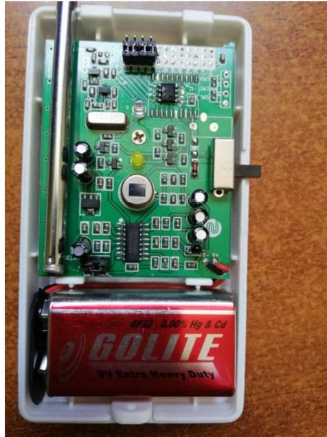
*Anexo B Figura 4 Cambio de batería Sensor PIR*
