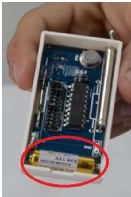
*Anexo B Figura 3 Cambio de batería sensor magnético*
