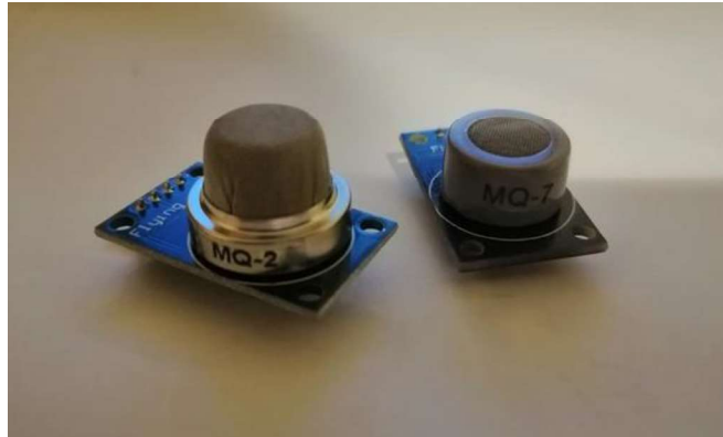
Figura 3.21 Sensores detección de gas
