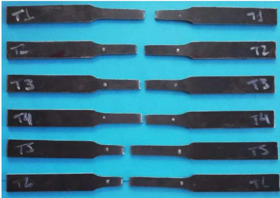
Figura 3.1. Probetas ensayadas de metal base.
