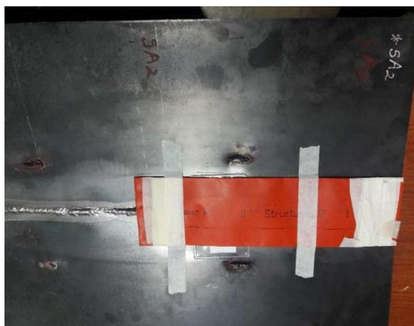
Figura 2.16. Probeta preparada con los ICI y película radiográfica.
