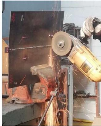
Figura 2.17. Corte de las probetas para ensayos mecánicos.
