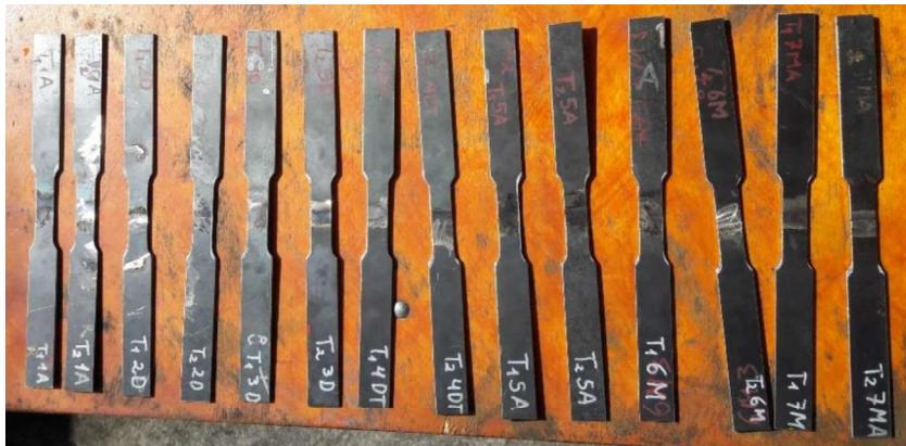
Figura 2.23. Probetas de tracción de sección reducida maquinadas.
