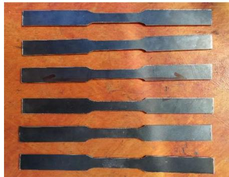
Figura 2.3. Probetas para ensayo de tracción del material base.
