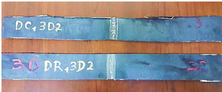
Figura 2.19. Probetas para el doblado de cara y raíz.
