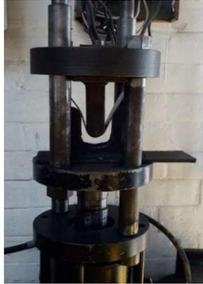
Figura 2.20. Deformación provocada por flexión en las probetas de doblado.
