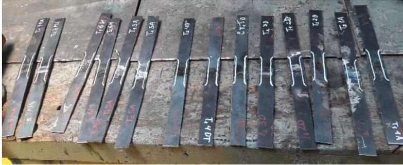
Figura 2.21. Probetas de tracción antes del maquinado.
