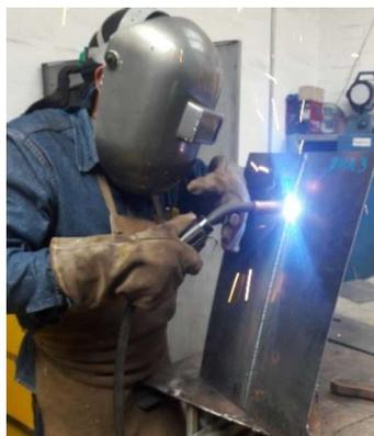
Figura 2.10. Soldadura de las probetas en la posición 3G.
