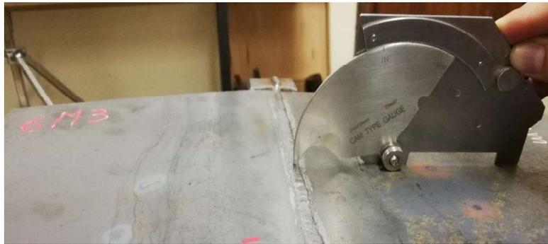
Figura 2.12. Medición de la cara y raíz de las juntas soldadas.
