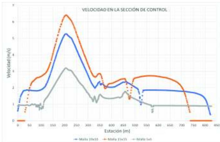
**Figura 3. 19** Velocidades en sección de control para análisis de sensibilidad
