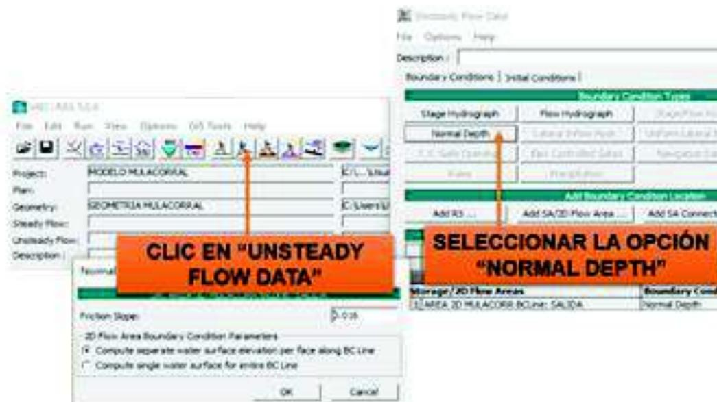
Existen diferentes formas para representar condiciones de borde para la rotura de presas, sin embargo, la que se utilizará en este ejemplo es “Normal Depth”.
