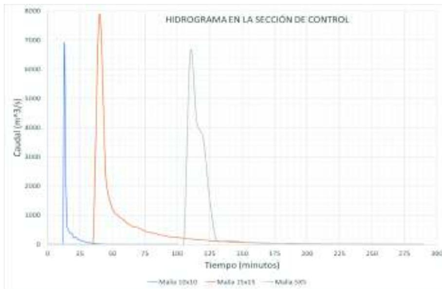
**Figura 3. 21** Hidrograma en sección de control para análisis de sensibilidad
