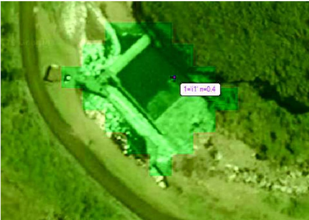
**Figura 3. 29** Coeficiente de rugosidad en zonas con infraestructura
