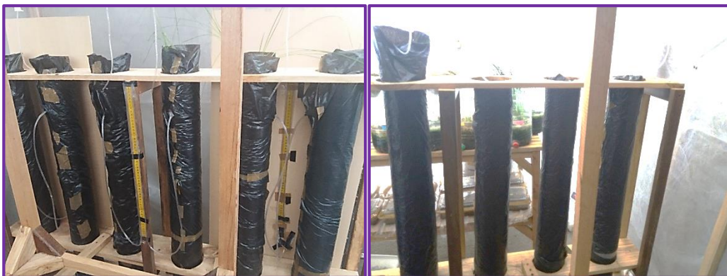
Figura 3. 5: Aclimatación final de las columnas de biofiltración
