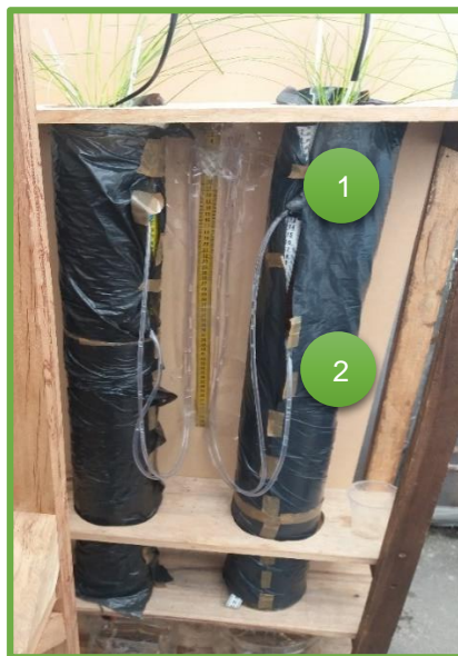
Figura 3. 8: Piezómetros instalados en las columnas de biofiltración
