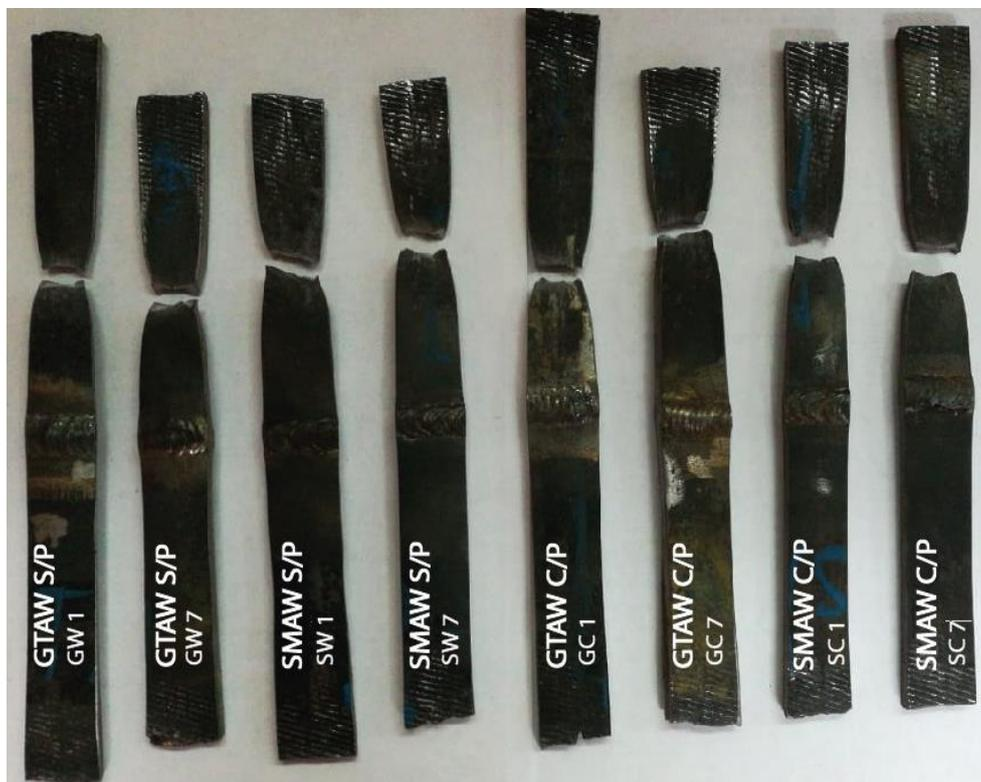
Figura 3-3 Probetas soldadas ensayadas a tracción.
