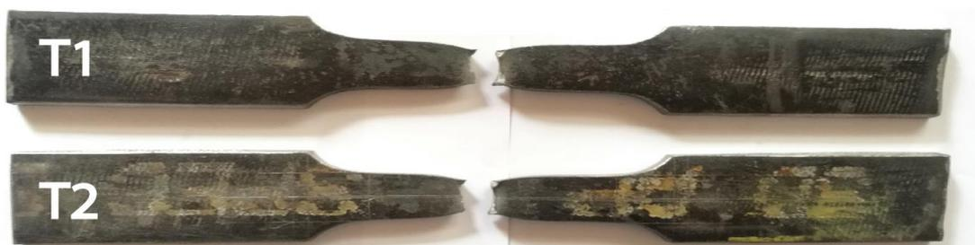
Figura 3-1 Probetas ensayadas a tracción.
