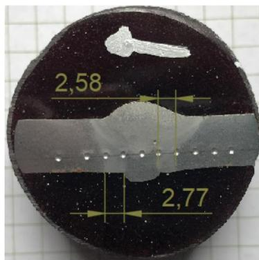
c) Probeta GTAW sin precalentamiento
