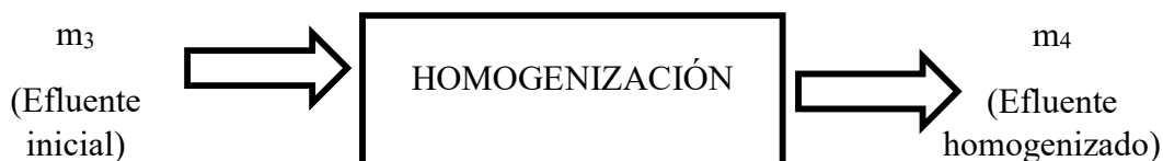
Figura AXII.1. Flujos en el tanque homogenizador
