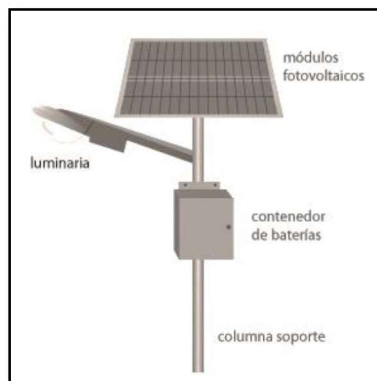
Figura 1.11. Elementos de una luminaria solar [internet]
