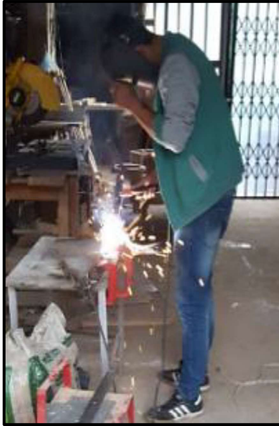
Figura 3. 17 Proceso de soldadura de estructura metálica.
