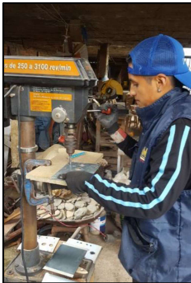
Figura3. 20 Perforación de las placas.
