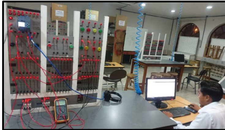
Figura 3.37 Prueba de conexión pc-LOGO con cable de red.
