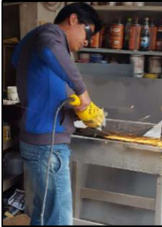
Figura 3. 18 Proceso de pulido de la estructura de soporte.
