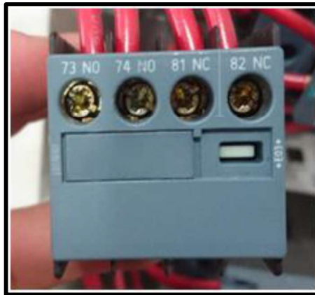
Figura 3.5 Contactos auxiliares para contactores SIRIUS Innovations 1NA+1NC.
