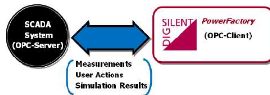
Figura 2.32. Esquema de un interfaz OPC para PowerFactory [26].
