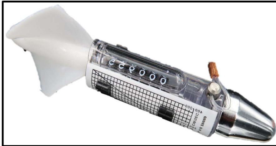
Figura 3.1 Micromolinete General Oceanics, modelo 2030 CF. Fuente: (General Oceanics, 2014). Modificado por el autor.
