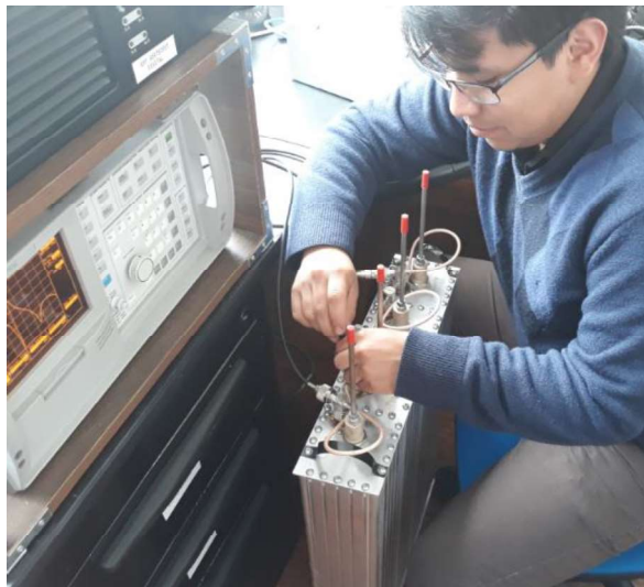
Figura 3.47 Calibración de frecuencias de rechazo en la etapa de recepción
