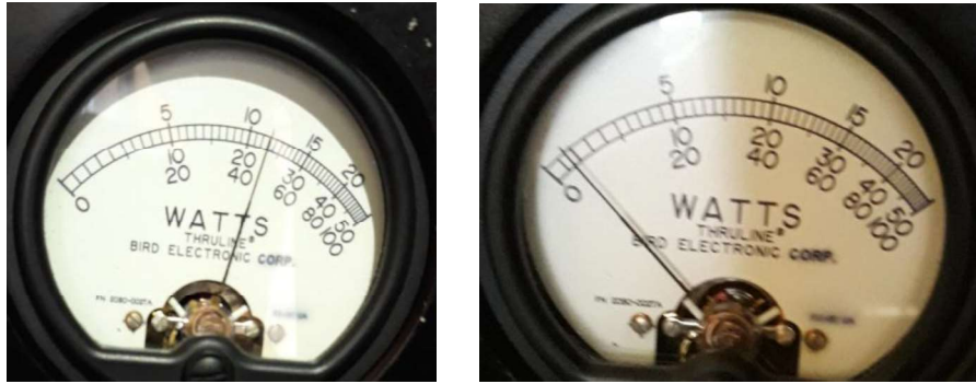
Figura 3.61 Potencia incidente y potencia reflejada
