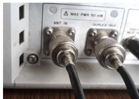
Figura 3.43 Terminales del analizador de espectros para calibración del duplexor
