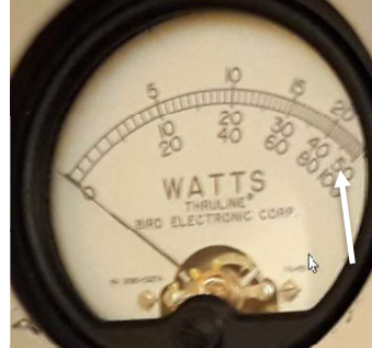
Figura 3.15 Escala del vatímetro bird
