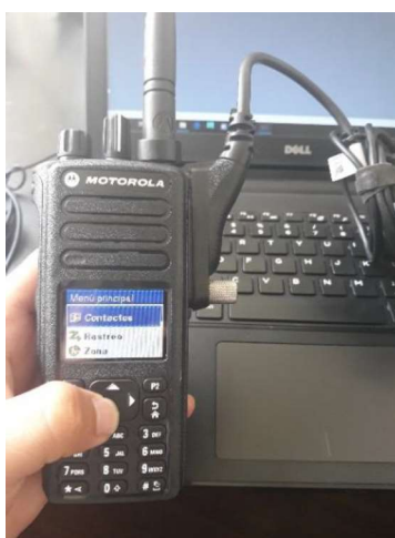
Figura 3.39 Portátil DGP8550 y cable de programación
