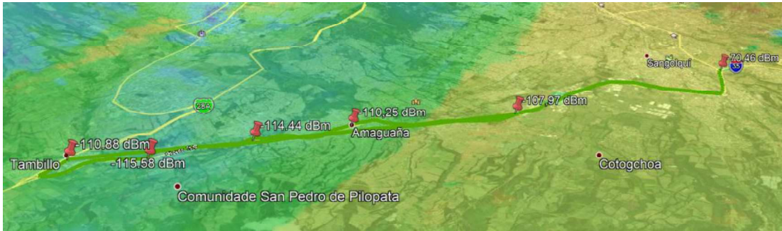
Figura 3.63 Cobertura en la zona de valle de Sangolquí hasta Tambillo
