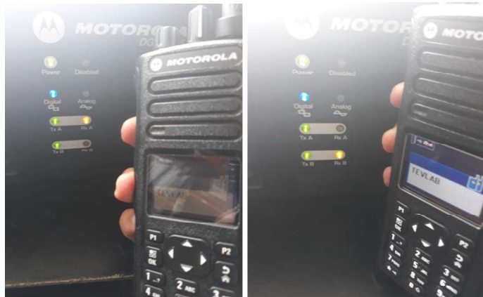
Figura 3.51 Prueba hacia el repetidor desde las dos ranuras de comunicación
