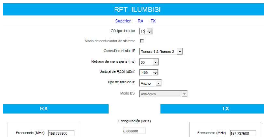
Figura 3.36 Configuración de frecuencias en sistema digital
