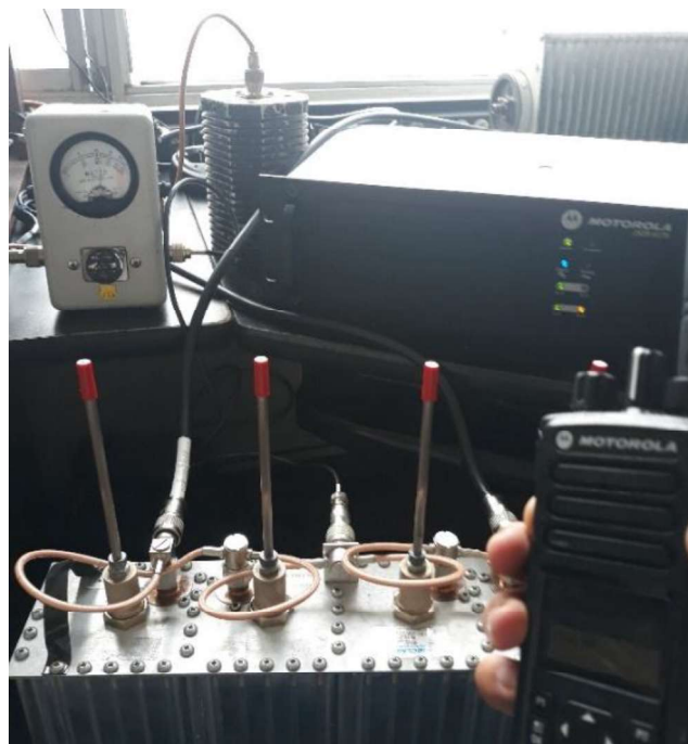
Figura 3.52 Conexión de duplexor y repetidora
