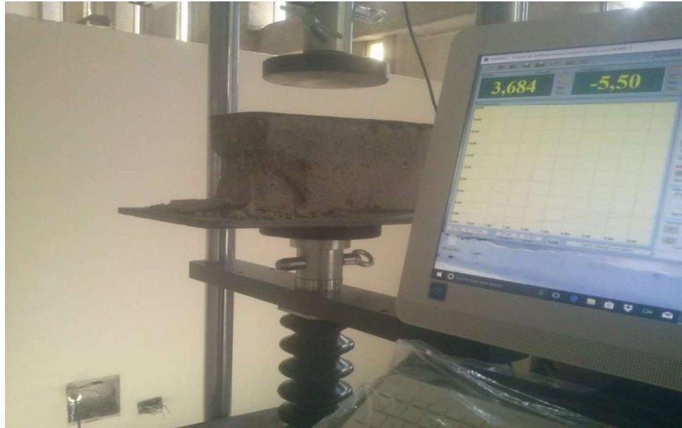
Figura 14. Ensayo de Resistencia a Compresión de Bloques
