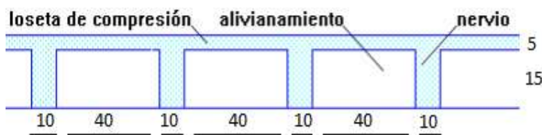
Figura 31. Componentes de un metro de losa tipo
