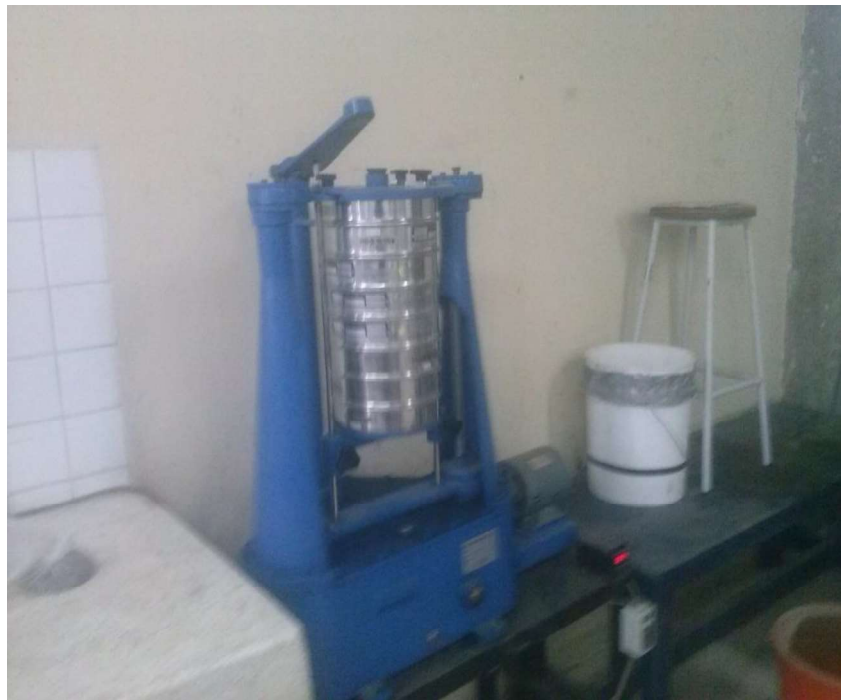
Figura 16. Ensayo de granulometría de arena
