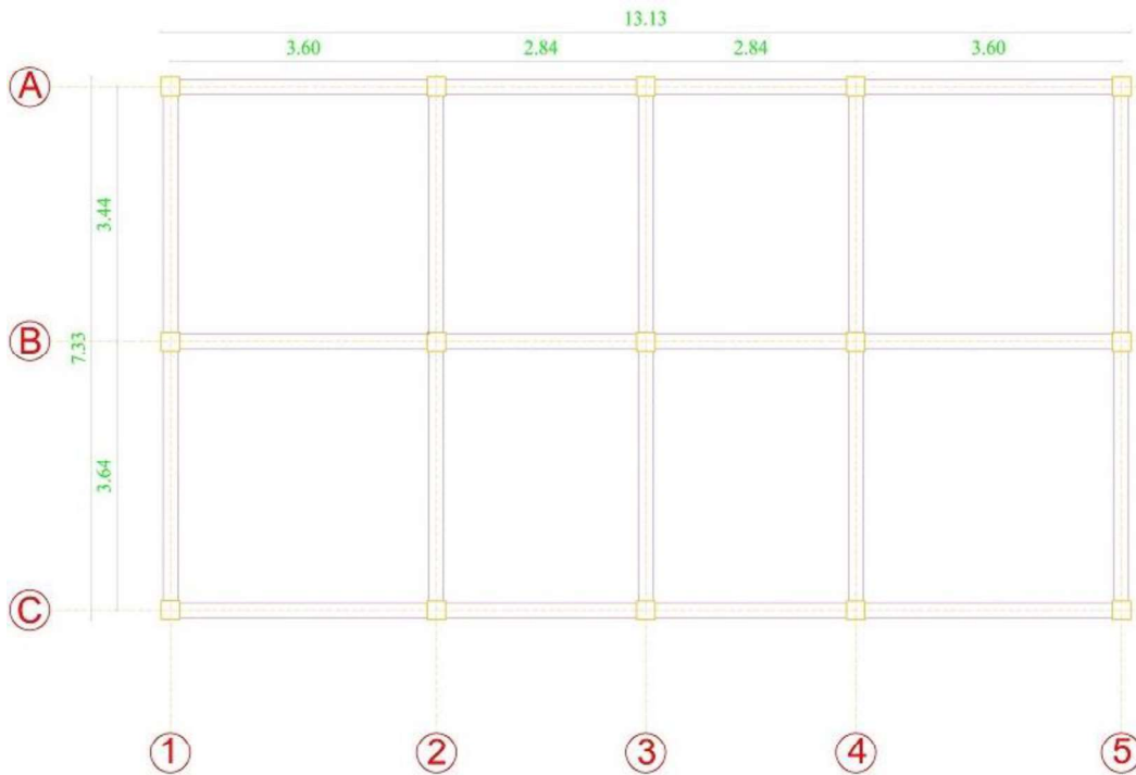
Figura 30. Diseño de vigas 20x20cm primero y segundo piso
