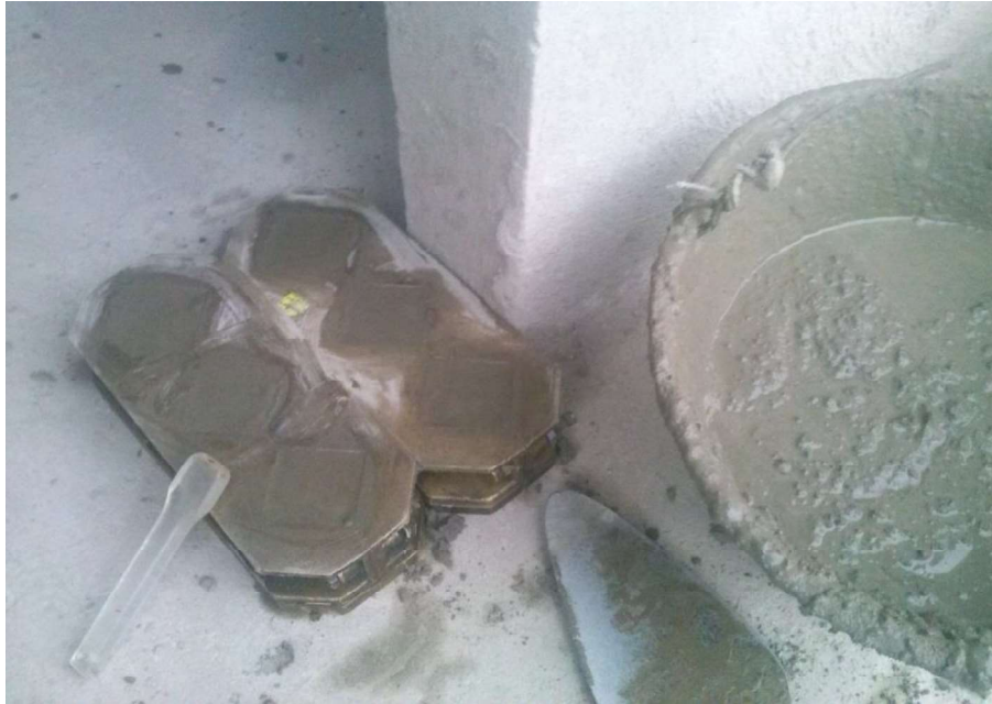
Figura 15. Toma de muestras de mortero en campo
