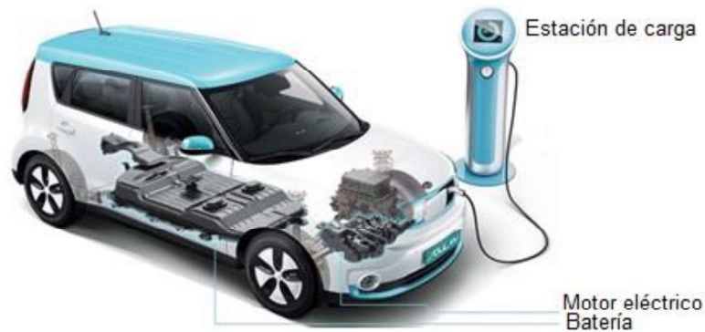
Figura 1.3. Componentes básicos de un vehículo eléctrico. (Fuente: [18])
