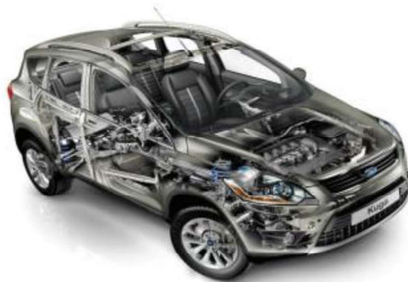
Figura 1.2. Componentes de un vehículo con MCI. (Fuente: [14])
