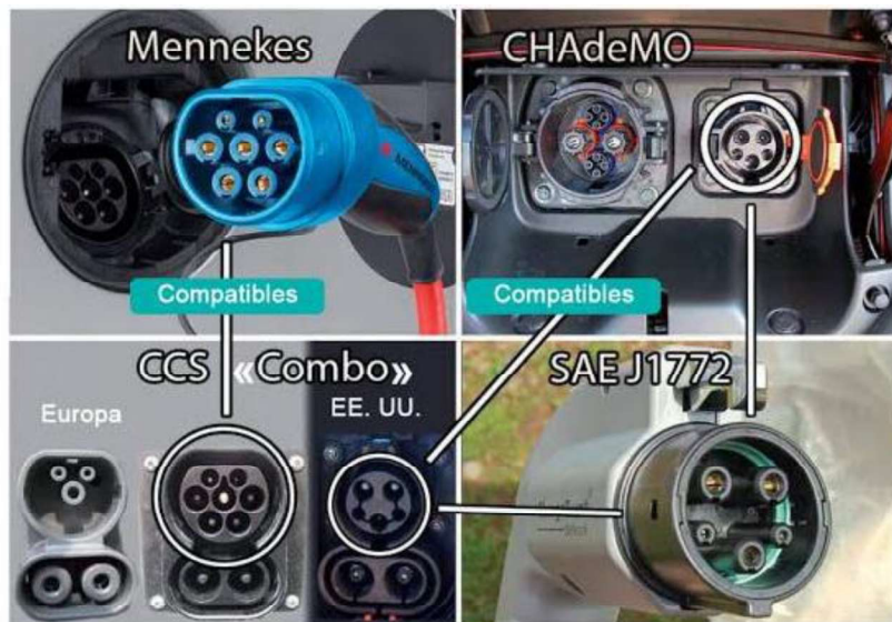
Figura 1.5. Ejemplos de enchufes para la carga de vehículos eléctricos. (Fuente: [19])
