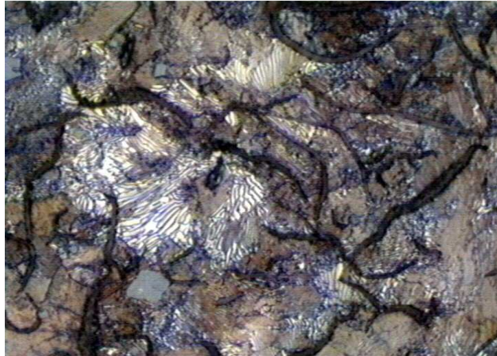
Figura1.17 Fundición Gris; Matriz Perlítica x200 3
