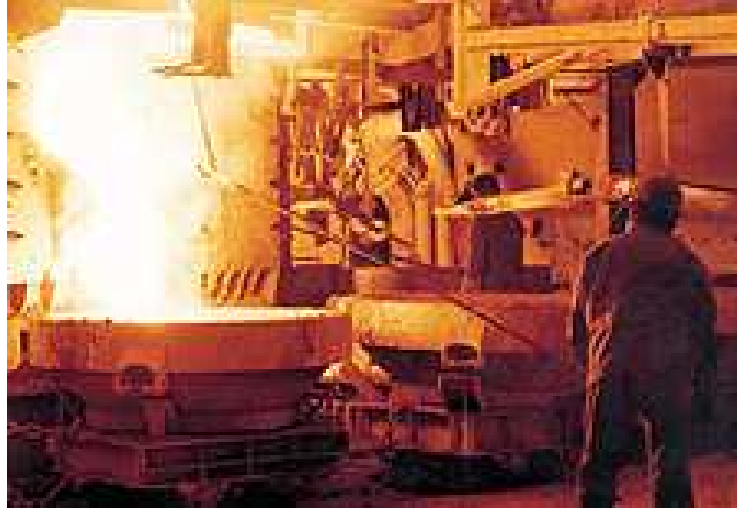
Figura 2.2 Adición de Carburo de calcio en la colada 19
