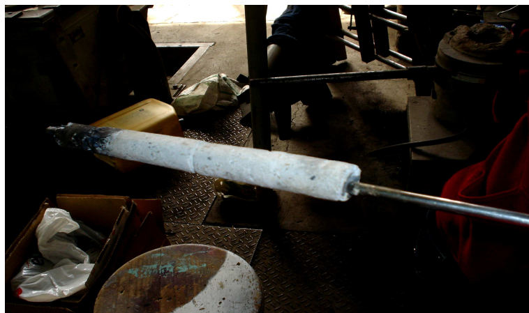
Figura 3.3 Lanza de acero inoxidable con recubrimiento refractario.
