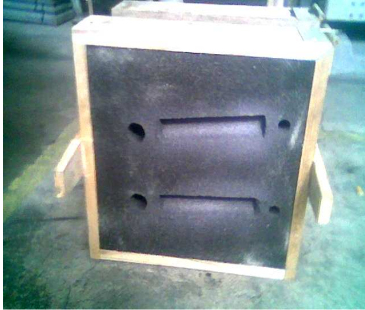
Figura 3.8 Moldeo en arena en verde
