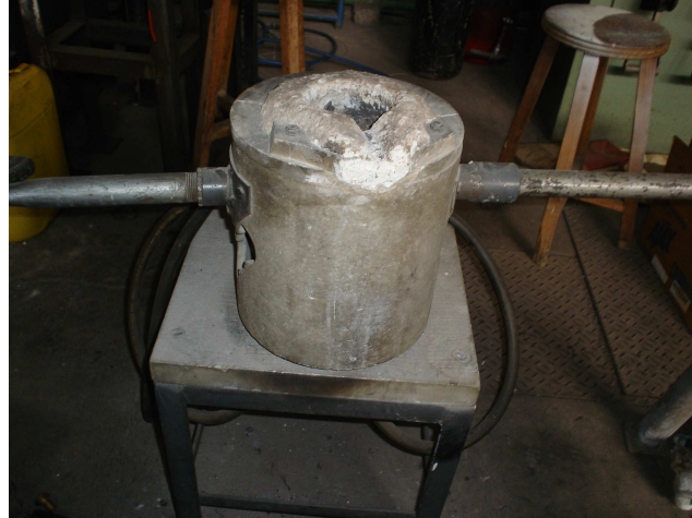
Figura 3.1 Horno de inducción (capacidad de 5 Kg)
