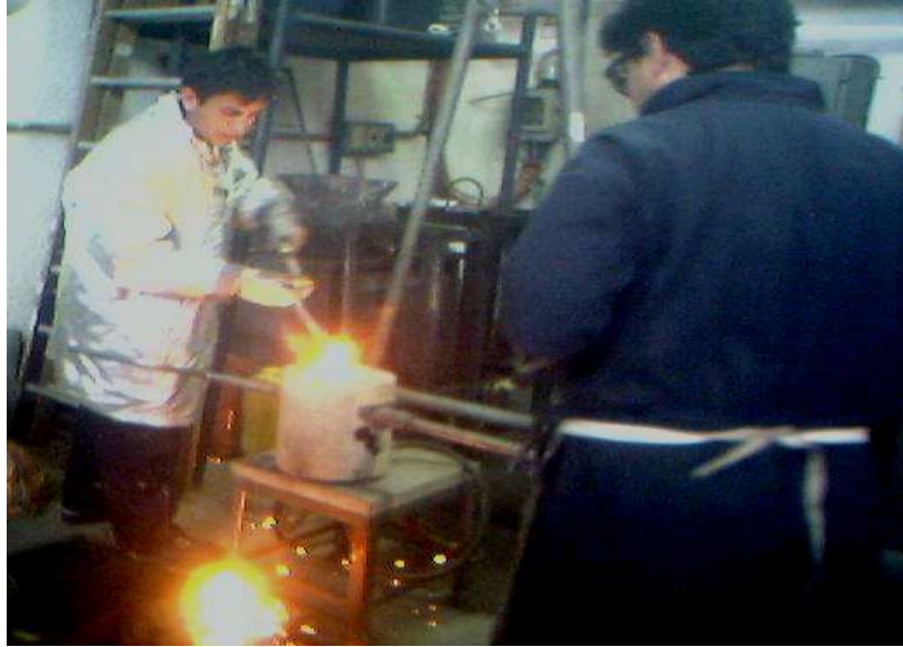
Figura 3.7 Eliminación de la escoria
