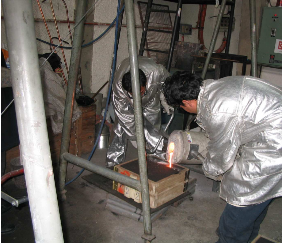
Figura 3.10 Colado del hierro gris desulfurado.
