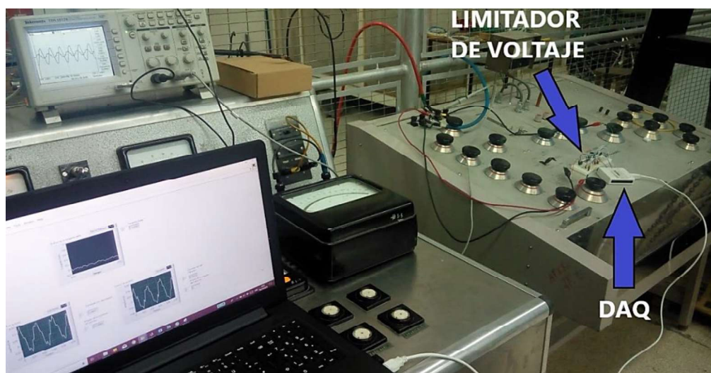
Figura 2.14. DDAQ conectado al puente de resistencias R_s , y a un computador. En la parte superior izquierda se observa la medición simultánea con el osciloscopio.
