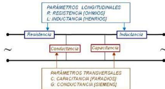
**Fig. 1.6** Parámetros de una línea de transmisión [6]
