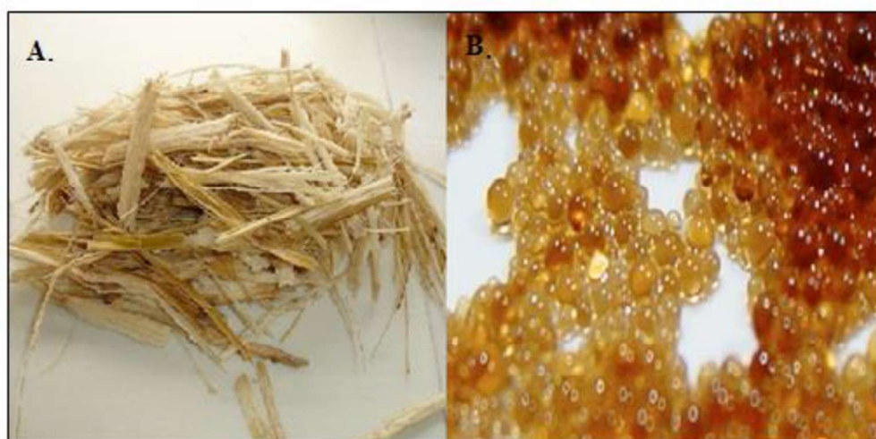
Figura 1.2. A. Soporte natural (bagazo de caña); B. Soporte inerte (amberlita IRC120 Na) (Rohm y Haas -Product Data Sheet, 2019)
