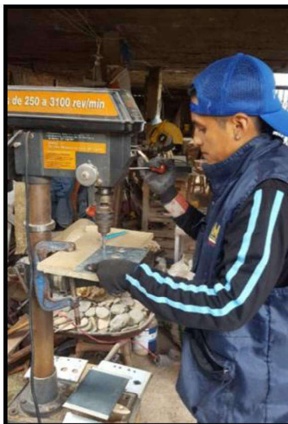
Figura 3.35 Perforación de las placas.
