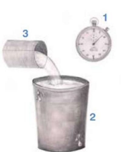
Figura 2. Método volumétrico para medición de caudal (VALENCIA, 2014)
