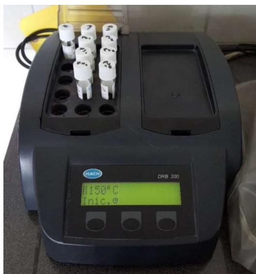
Figura 15. Digestor de DQO
