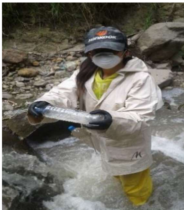
FIGURA 3.2. TOMA DE ALÍCUOTA DURANTE EL MUESTREO COMPUESTO.
