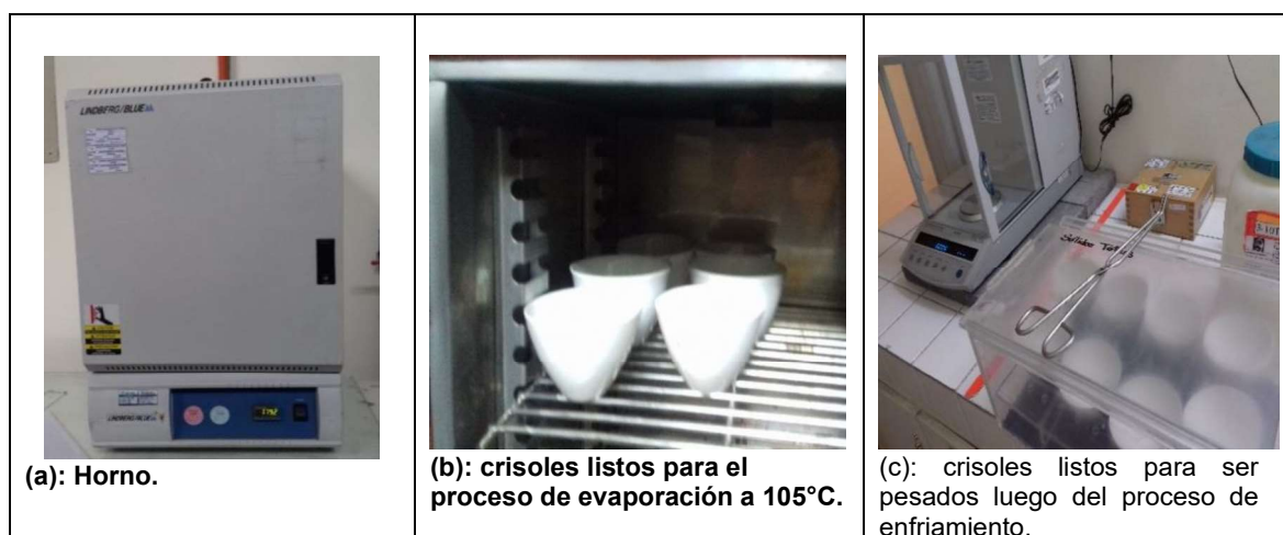
FIGURA 3.7. ENSAYO DE SÓLIDOS TOTALES.
