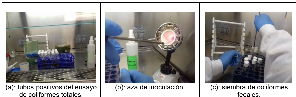
FIGURA 3.34. ENSAYO DE COLIFORMES FECALES.
