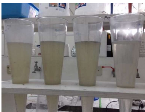
FIGURA 3.9. ENSAYO DE SÓLIDOS SEDIMENTABLES.
