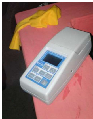
FIGURA 3.6. NEFELÓMETRO PARA MEDIR LA TURBIEDAD DE LAS ARD.
